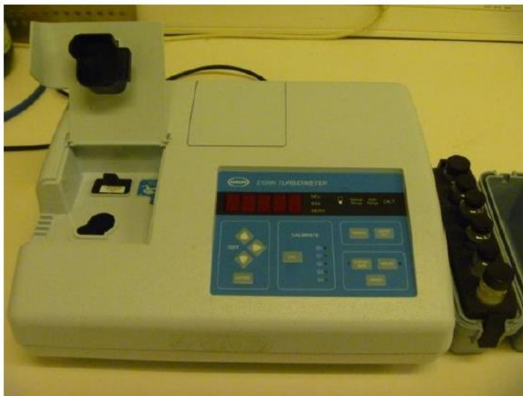
Εικόνα 24 Θολερόμετρο HACH 2100N
