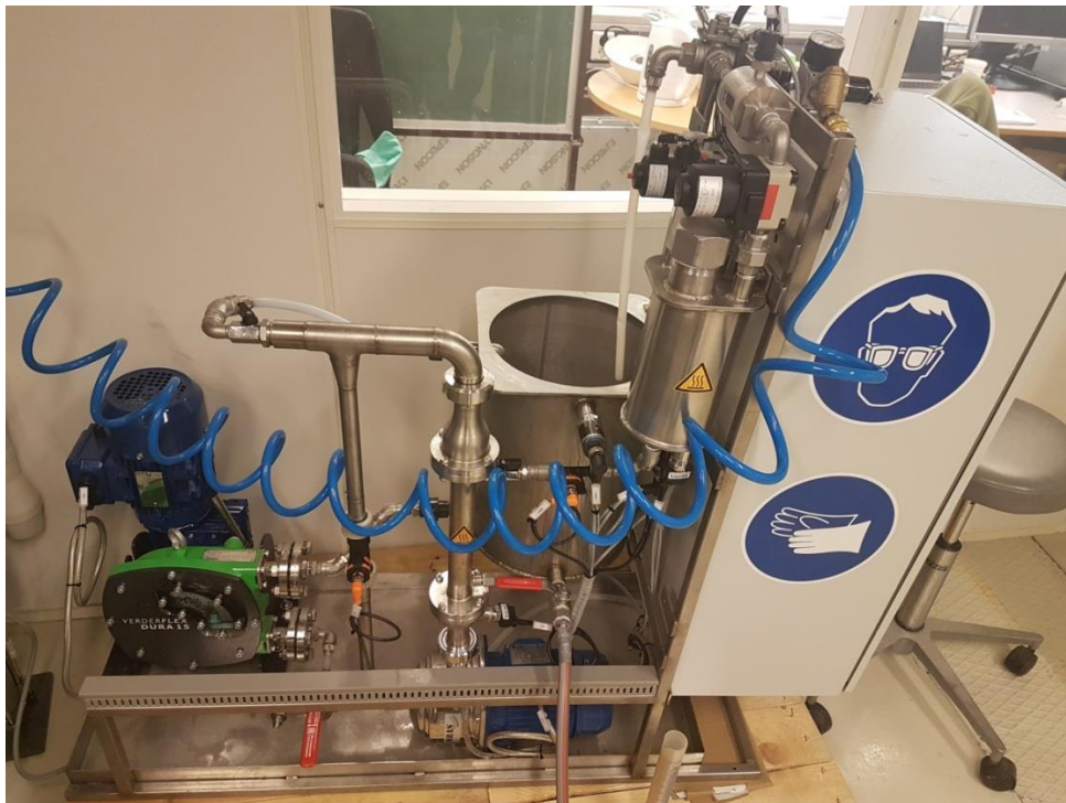
Εικόνα 2. Μηχανισμός μεμβράνης σε εργαστήριο του Πανεπιστημίου του Stavanger, Νορβηγία.
