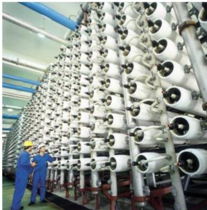
Εικόνα 5. Τυπική μονάδα αφαλάτωσης με μεμβράνες αντίστροφης ώσμωσης
