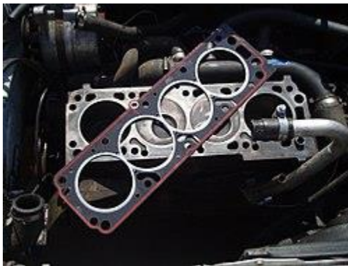
Εικόνα 45: Παρέμβυσμα πάνω από μπλοκ τετρακύλινδρου κινητήρα αυτοκινήτου. [4]
