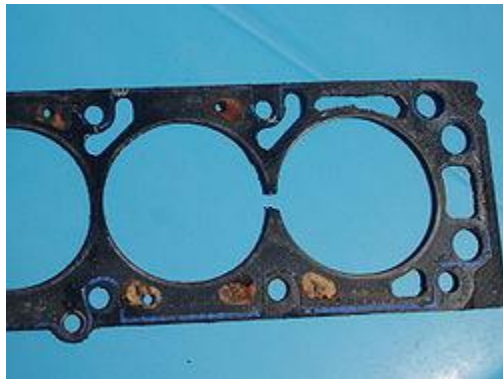
Εικόνα 46: Φθορά σε Παρέμβυσμα Κεφαλής [4]
