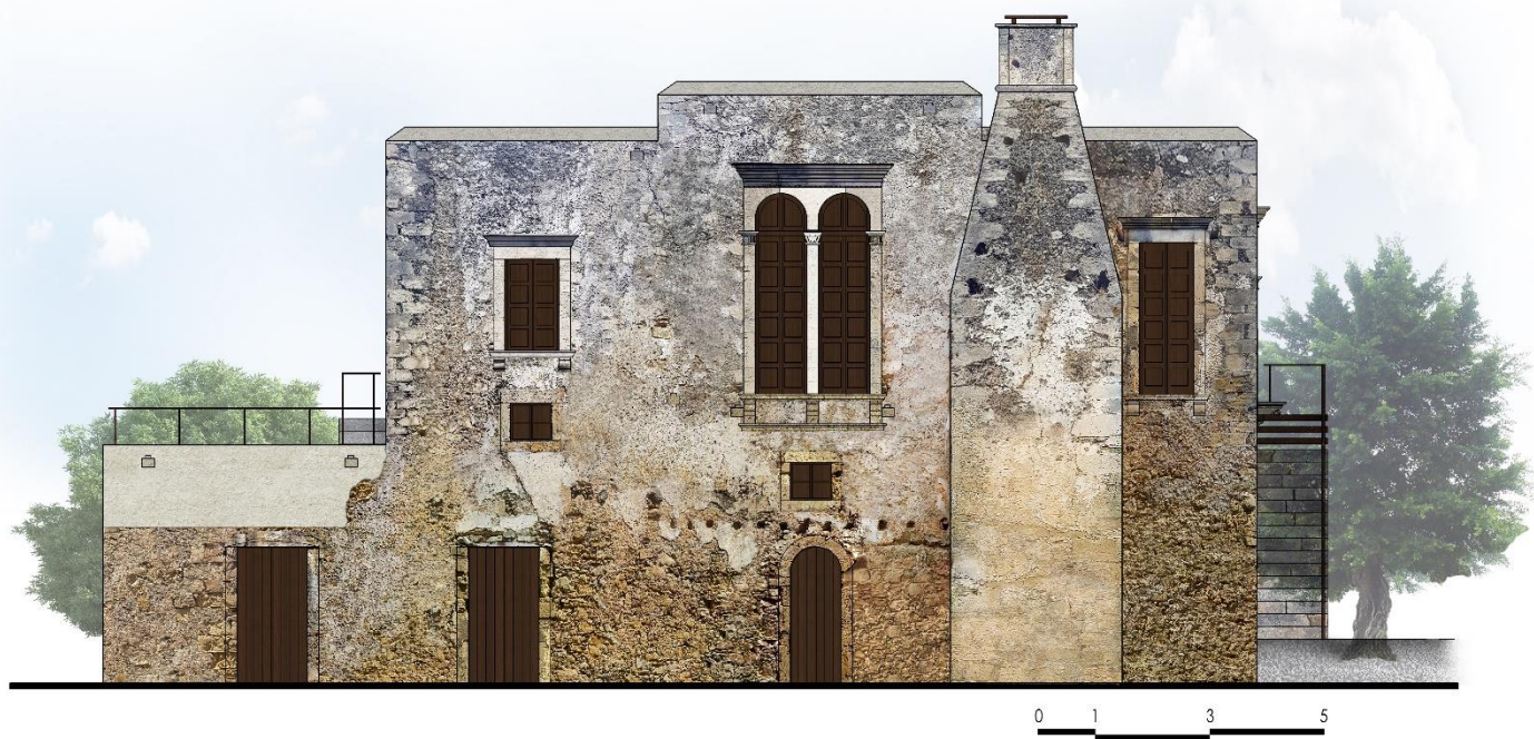
εικ.144_ πρόταση αποκατάστασης και επανάχρησης_ δυτική όψη
