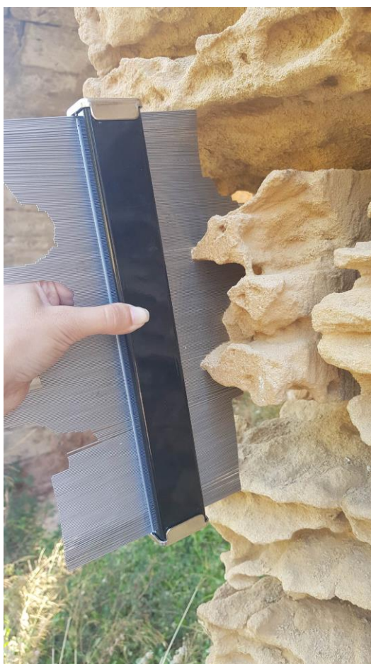
εικ.94_ αποτύπωση διάβρωσης πωρόλιθου με προφιλόμετρο
