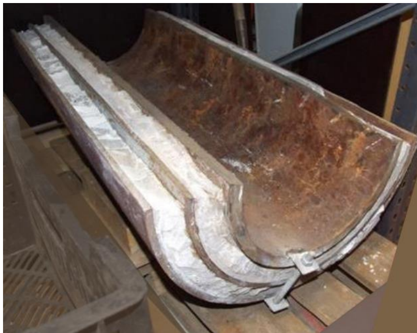
Εικόνα 3 : Διατομή των τσιμεντωμένων περιβλημάτων που ανασκάφηκαν από γεωθερμικό πηγάδι υψηλής θερμοκρασίας στο Ρέκιανες της Ισλανδίας, παρουσιάζοντας τη στρωματοποιημένη δομή των περιβλημάτων και μονωτικών θηκών τσιμέντου (πηγή: (Skúlason Kaldal Gunnar -High-Temperature Geothermal Wells 2019).
