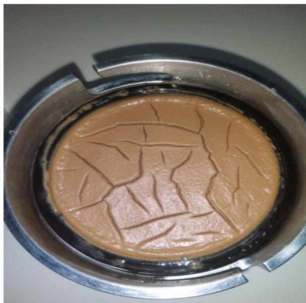
Εικόνα 6: Υμένιο μετά την απώλεια διήθησης (filtercake) (πηγή: Φωτογραφίες διπλωματικής)
