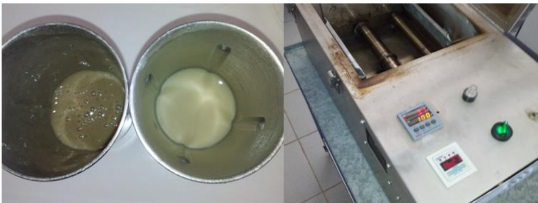
Εικόνα 5: Πολφοί και φούρνος γήρανσης με περιστρεφόμενους άξονες (πηγή: Φωτογραφίες διπλωματικής)
