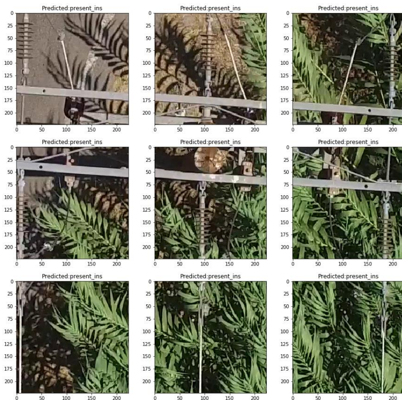
Εικόνα 66 Παραδείγματα Κατηγοριοποίησης Εικόνων για μονωτήρες μέσης τάσης
