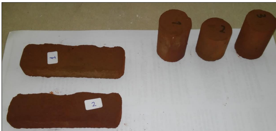
Εικόνα 48: Κεραμικά δοκίμια φαυλιτικής σκωρίας μετά την έψηση στους 900°C.
