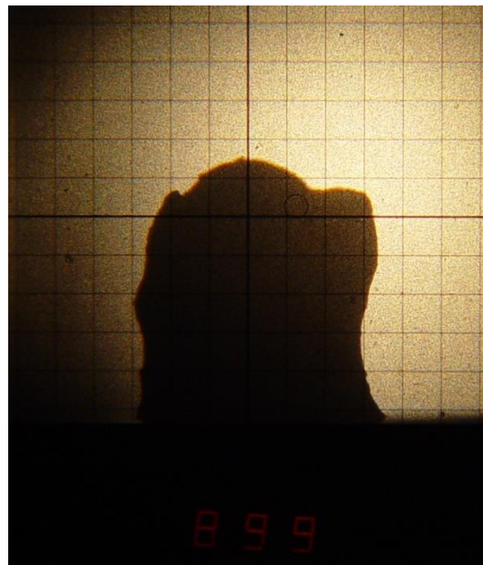
Εικόνα 17: Θερμοκρασίας παραμόρφωσης μείγματος γυαλιού - Φ.Σ. T_D = 899 °C.
