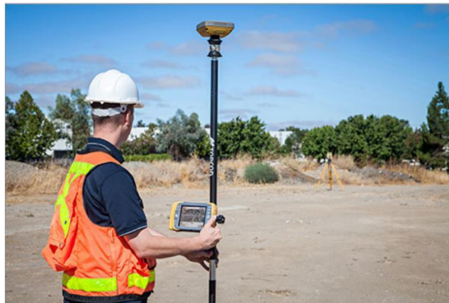
Εικόνα 3.2: Topcom GPS σταδία/κοντάρι και tablet για καταγραφή συντεταγμένων (GPS world, n.d.)
