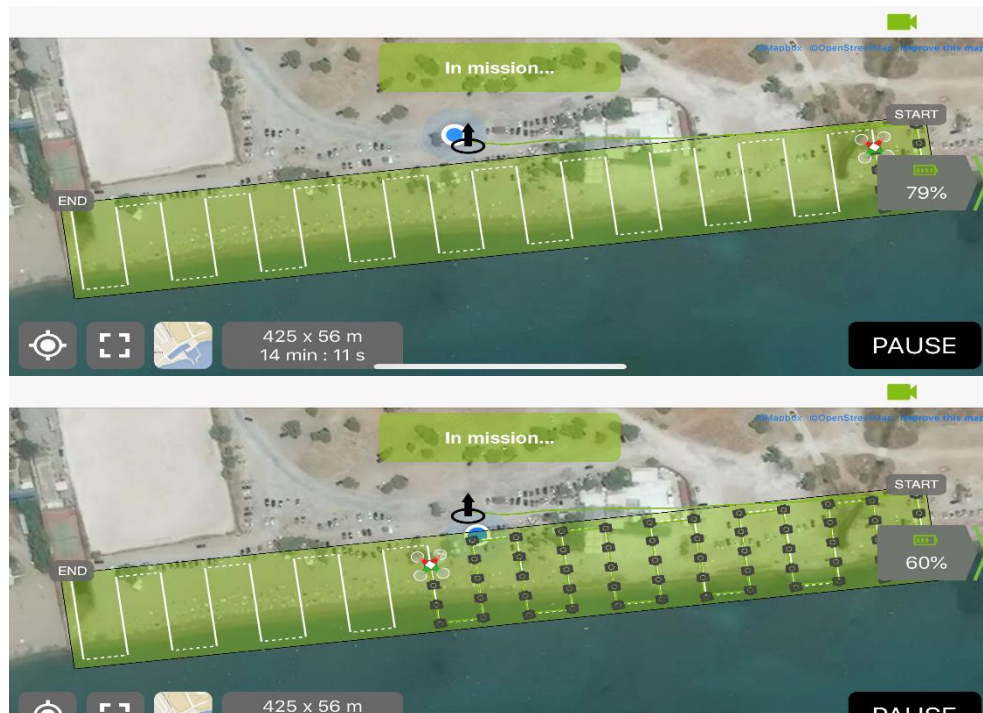
Εικόνα 4.1: Στιγμιότυπα του περιβάλλοντος DJI Ground Station Pro κατά τη διάρκεια πτήσης
