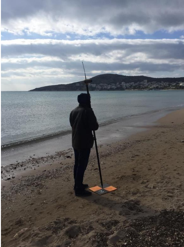
Εικόνα 4.4: Καταγραφή του επίγειου σημείου ελέγχου με αριθμό 3
