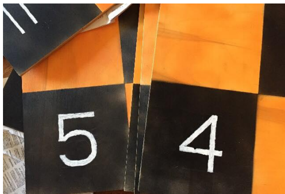
Εικόνα 4.3: Μορφή επίγειων σημείων ελέγχου- φωτοσταθερών
