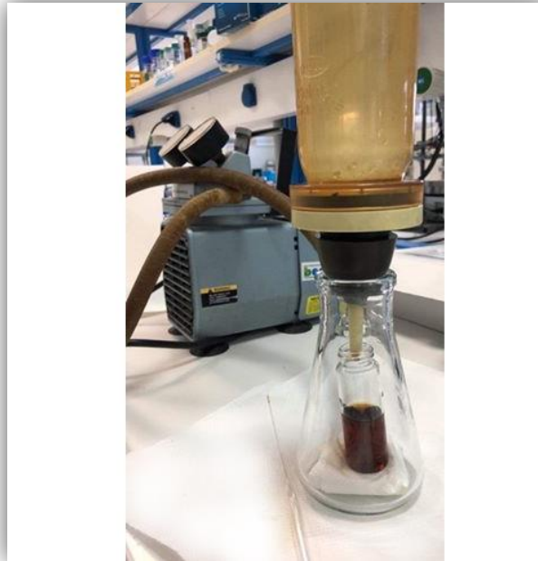
Εικόνα 12: Διαδικασία διήθησης των δειγμάτων μετά το πέρας της έκπλυσης με τη βοήθεια συσκευής διήθησης.
