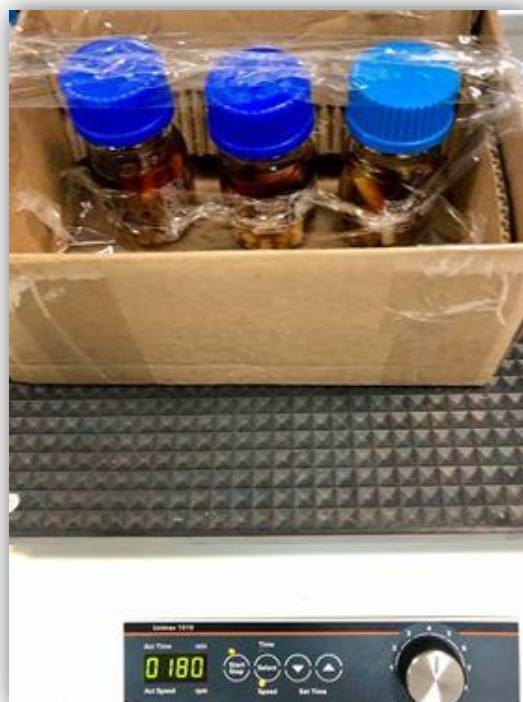
Εικόνα 11: Διαδικασία ανάδευσης των δειγμάτων σε 180 rpm
