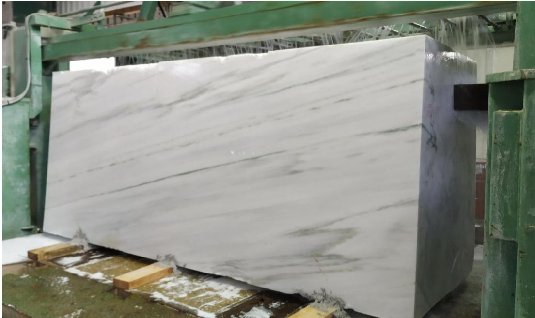
Εικόνα 45: Όγκος στο τελάρο, κόντρα κοπή.
