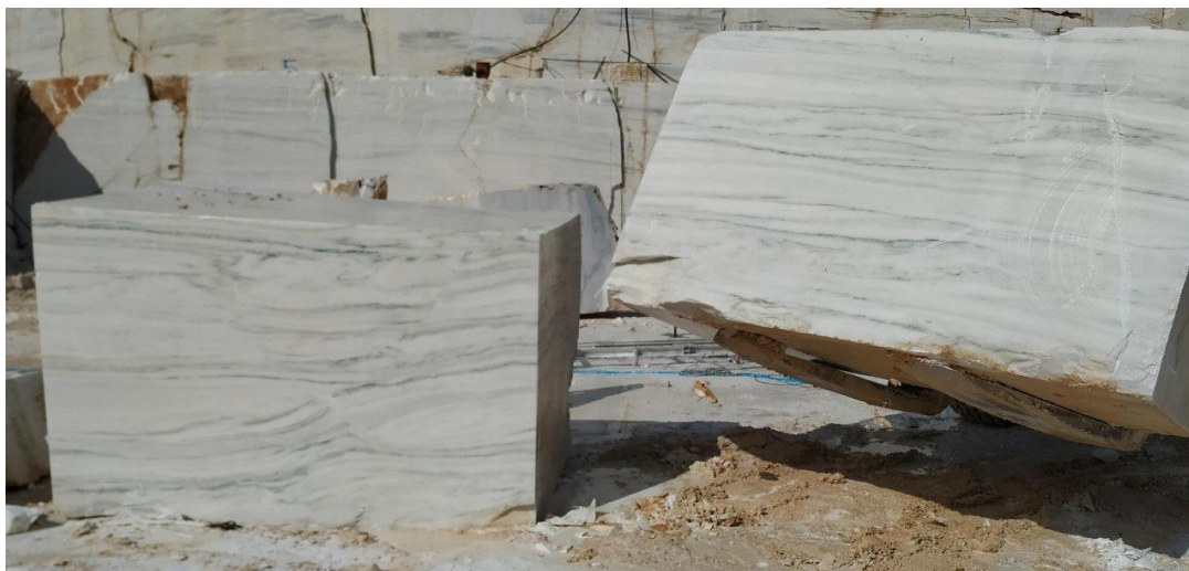
Εικόνα 64: Άποψη των ορθογωνισμένων πλέον όγκων που θα διατεθούν προς πώληση ως έχουν, με διαστάσεις 1.45m \times 1m \times 1.3m ( 2m^3 ) ο αριστερά και 1.65m \times 1m \times 1.3m ( 2m^3 ) ο δεξιά.
