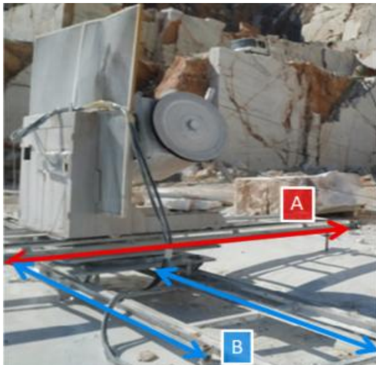
Εικόνα 21: Συρματοκοπή MARINI.
