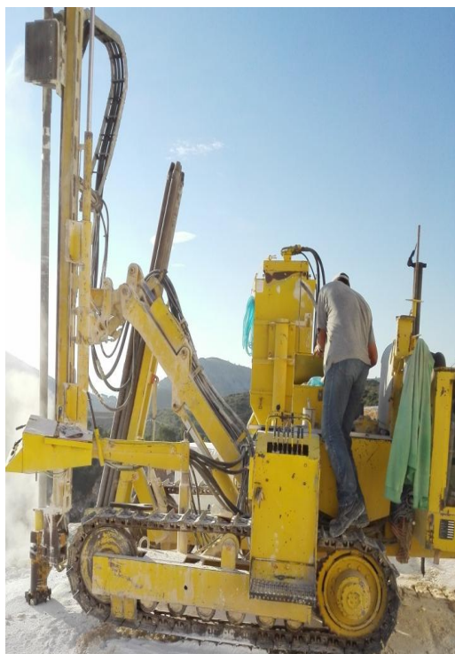
Εικόνα 18: Wagon Drill.
