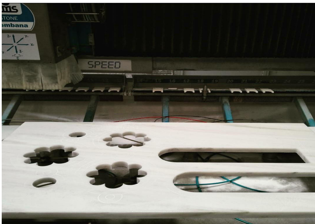
Εικόνα 58: Παράδειγμα δυνατοτήτων εφαρμογής κοπής με CNC κόπτη.
