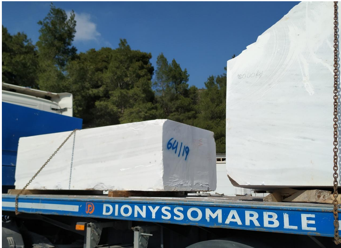
Εικόνα 25: Φορτηγό - Πλατφόρμα μεταφοράς όγκων, με μέγιστο επιτρεπόμενο φορτίο 60 τόνους.
