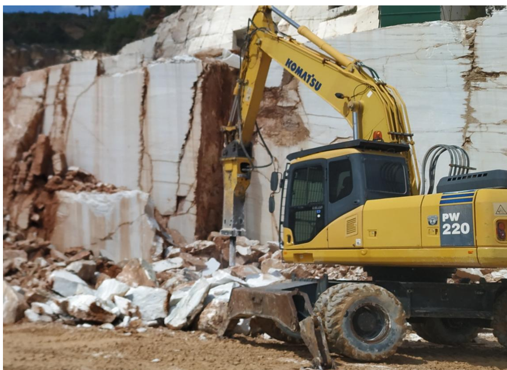
Εικόνα 37: Υδραυλική Σφύρα επί τω έργω.
