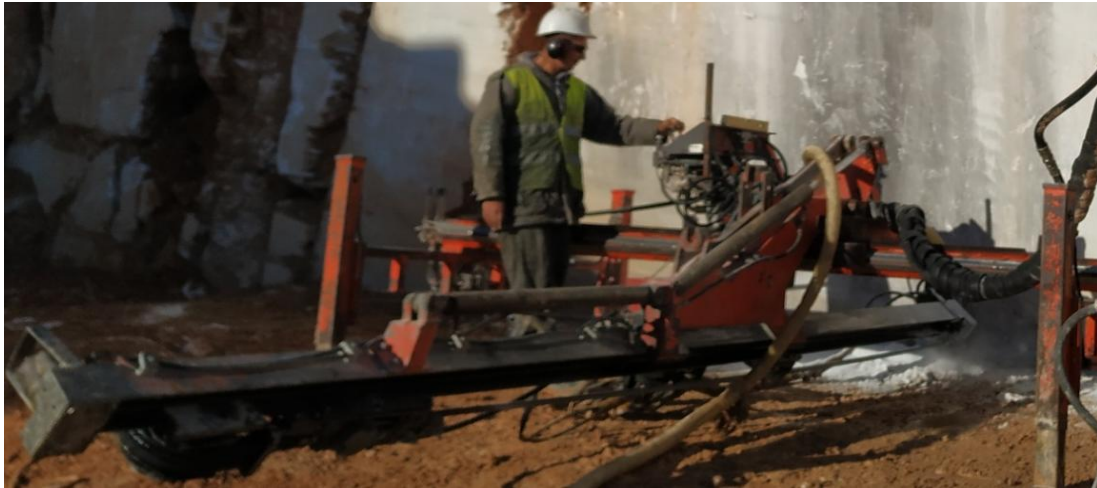
Εικόνα 20: Το βαγόνι - πλαίσιο του Liner της εικόνας 18.
