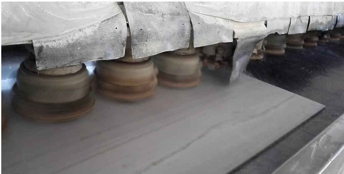
Εικόνα 50: Κεφαλές λουστραρίσματος.
