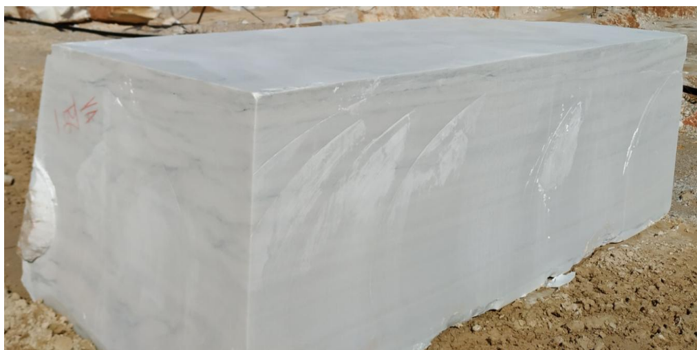
Εικόνα 65: Άποψη υγιούς όγκου της Β6 προς απευθείας πώληση από αυτήν. Διαστάσεων 3.5m \times 0.85m \times 1.5m ( 4.5m^3 ).
