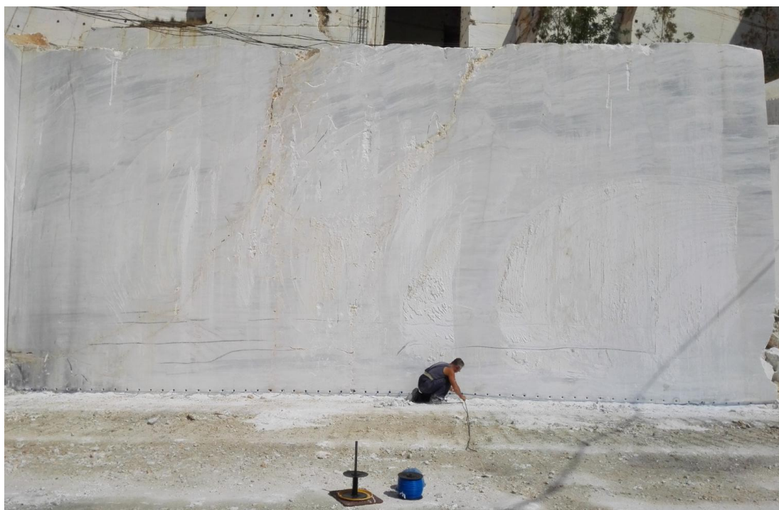
Εικόνα 33: Άποψη της διαδικασίας γόμωσης για το σχίσμο του πάτου.
