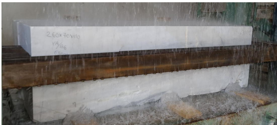
Εικόνα 63: Άποψη όγκου της Β6 υπό κόντρα κοπή στο τελάρο. Διαστάσεων 2.60m \times 0.70m \times 1.10m ( 2m^3 ).
