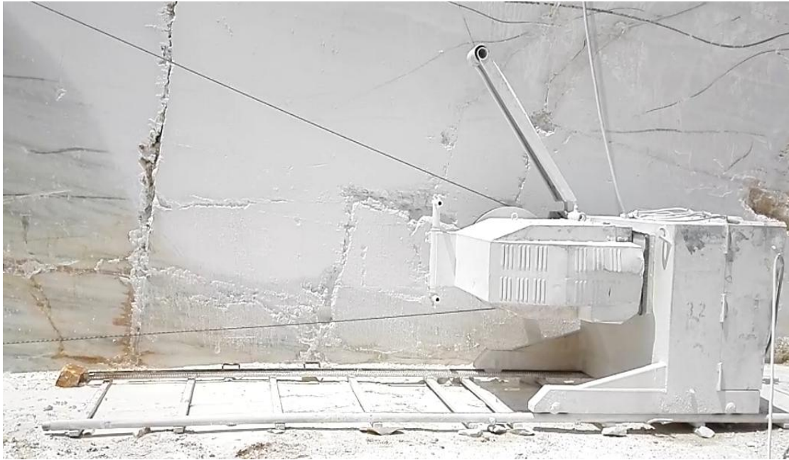
Εικόνα 31: Συρματοκοπή επί τω έργω.
