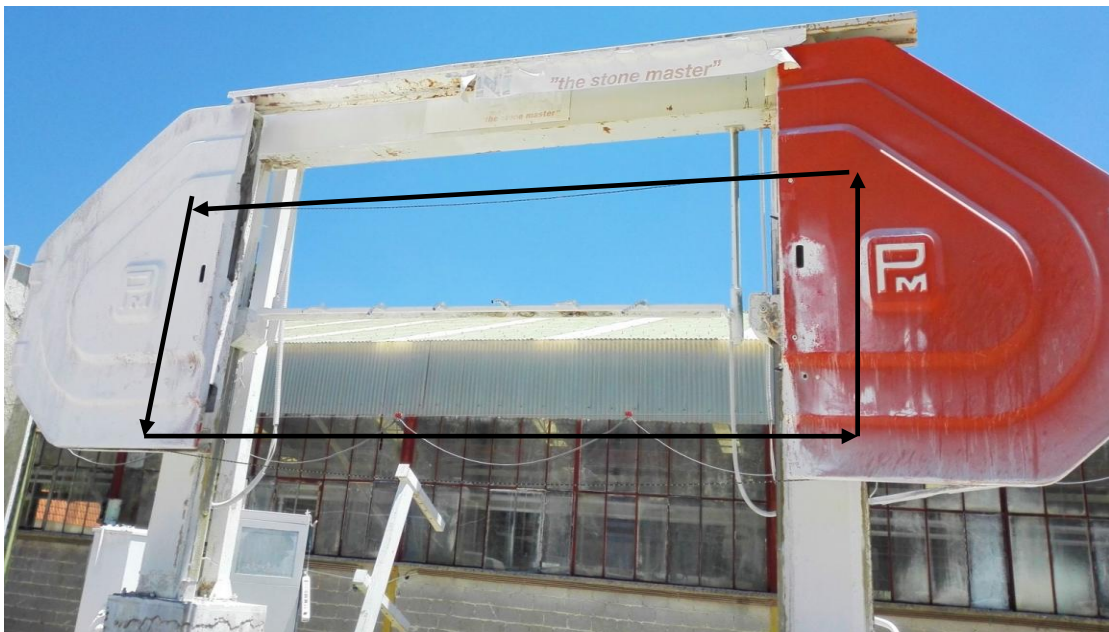
Εικόνα 44: Αποψη του μονόσυρμου σταθερού πλαισίου.
