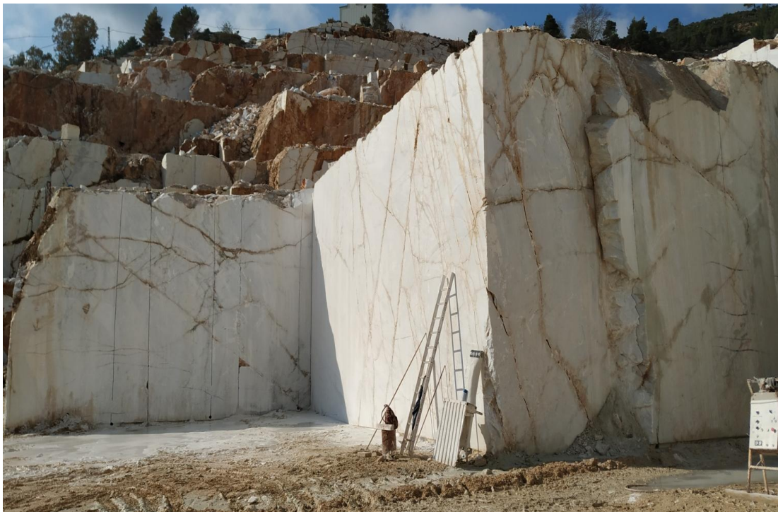
Εικόνα 71: Άποψη του σημείου παραγωγής και του βαθμού τεκτονισμού της Βαθμίδας Γ11.
