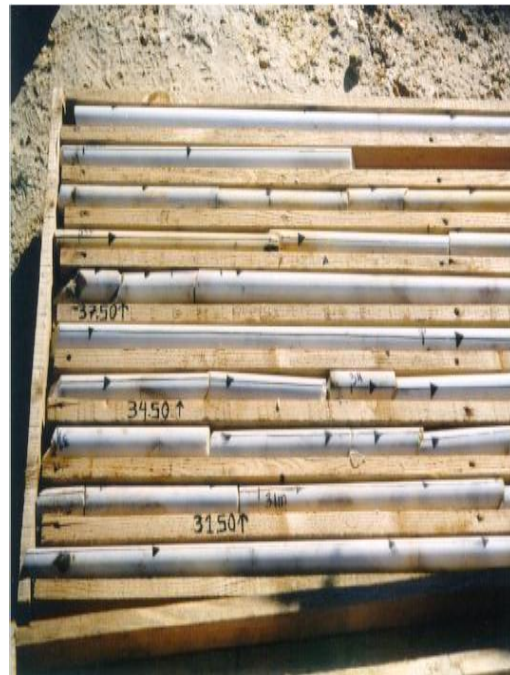
Εικόνα 12: Δειγματοληπτικοί πυρήνες - Καρότα.
