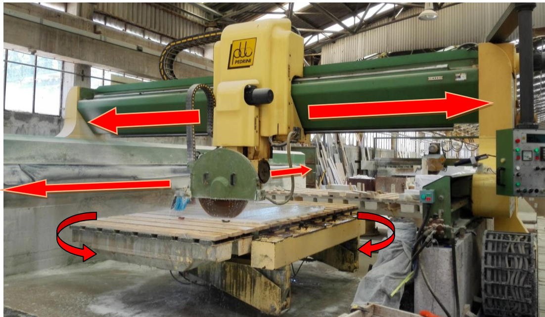
Εικόνα 47: Ενδεικτική άποψη σύγχρονης φρέζας με περιστρεφόμενη τράπεζα, προσαρμοσμένη σε γερανογέφυρα (γεφυρωτός κόφτης).
