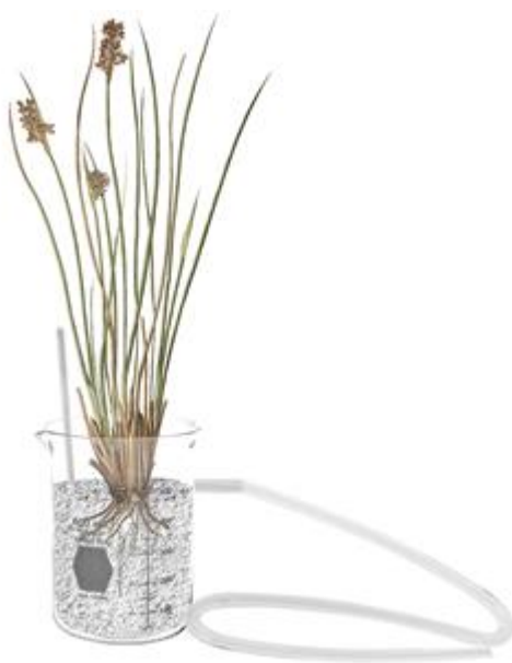
Εικόνα 11 Σχηματική απεικόνιση της υδροπονικής διάταξης. Το υλικό μέσα στο ποτήρι είναι μεσαίου μεγέθους χαλίκι. Από την πιπέτα γινόταν εισαγωγή του δείγματος, ενώ το σωληνάκι κατέληγε σε tubes που εκχυνόταν το επεξεργασμένο δείγμα
