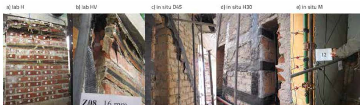
Εικόνα 56. Μηχανισμοί αστοχίας ενισχυμένων και μη δοκιμών.
