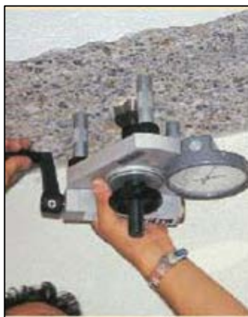
Εικόνα 22. Έλεγχος της επιφάνειας του σκυροδέματος με τη μέθοδο του εξολκέα όπως φαίνεται στη φωτογραφία
