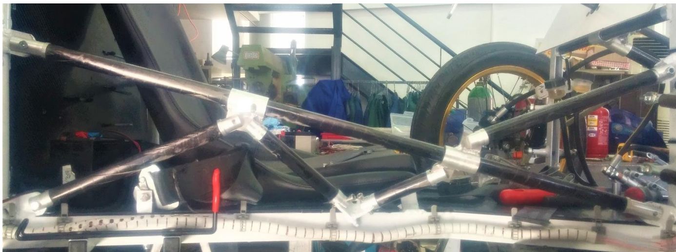
Εικόνα 5.7 Χωροδικτύωμα από ανθρακόνημα
