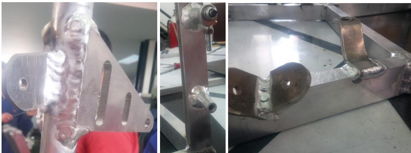
Εικόνα 5.3 Συγκολλημένα μέρη πλαισίου από αλουμίνιο
