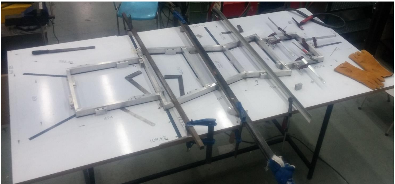
Εικόνα 5.1 Κατασκευή πλαισίου από αλουμίνιο
