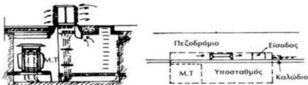
Εικόνα 1.11. : Υπόγειος υποσταθμός Διανομής.
