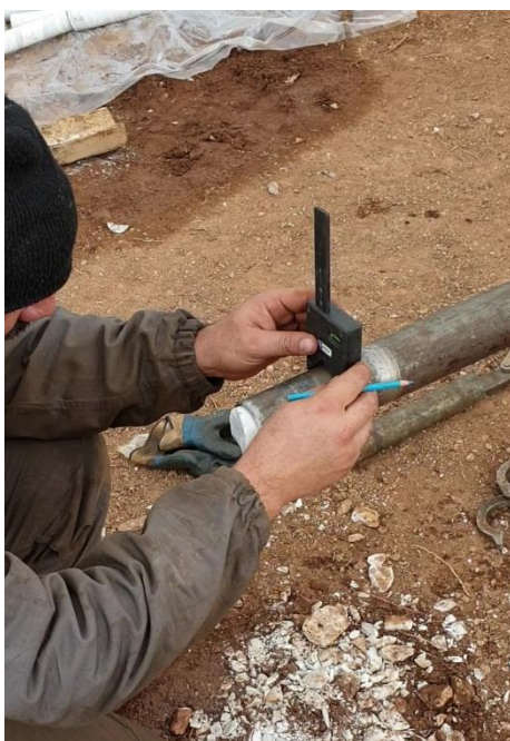
Εικόνα 36-Μαρκάρισμα πυρήνα αφού έχει προσανατολισθεί
