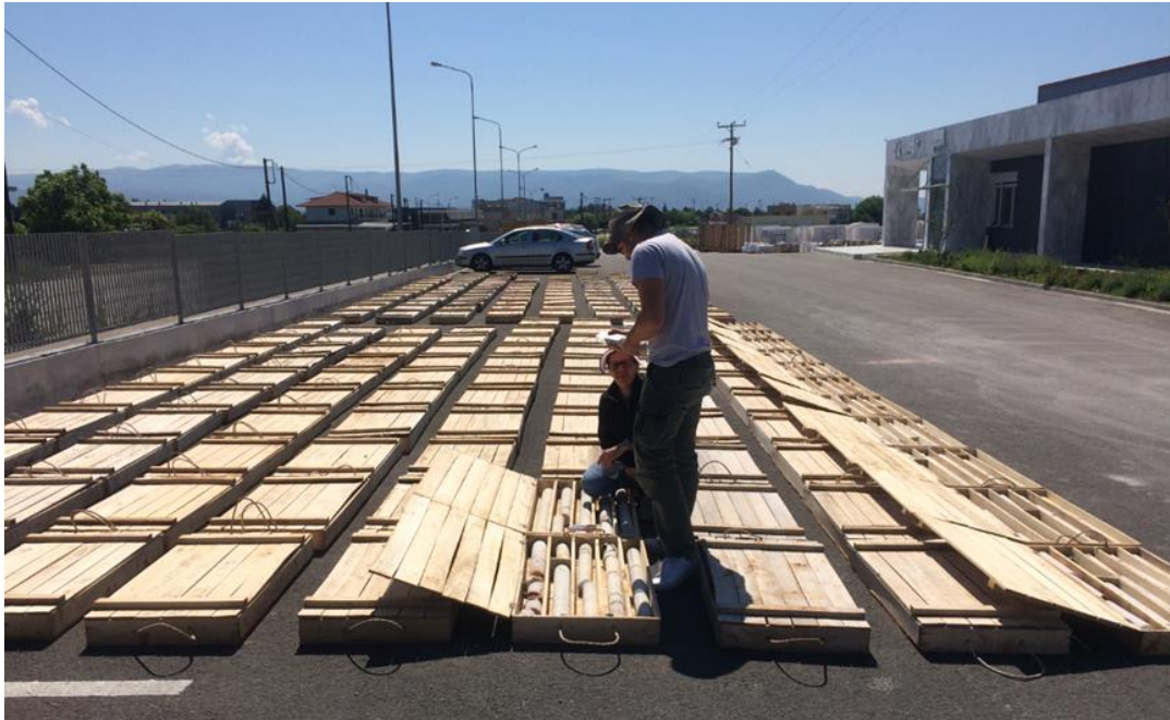
Εικόνα 38-Κασόνια πυρήνων μαρμάρου που μεταφέρθηκαν από το χώρο των γεωτρήσεων στο λατομείο
