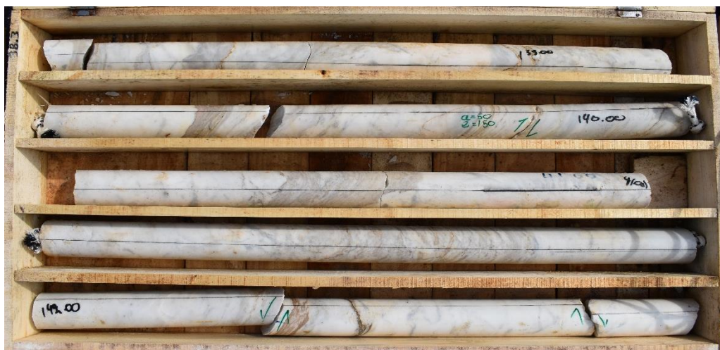
Εικόνα 39-Κασόνι τοποθέτησης προσανατολισμένου πυρήνα και ίχνος στο πάνω μέρος του πυρήνα
