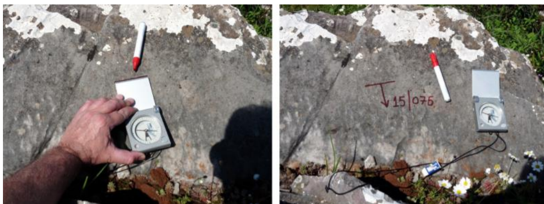
Εικόνα 22-Χρήση γεωλογικής πυξίδας για μέτρηση κλίσης και διεύθυνσης κλίσης μιας ασυνέχειας στο μέτωπο (Λόζιος, 2015)
