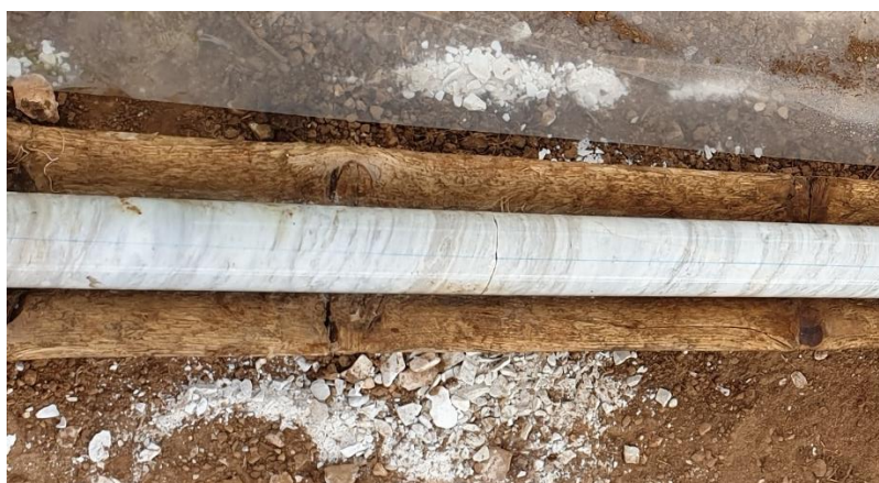
Εικόνα 11-Πυρήνας γεώτρησης μαρμάρου (φωτογραφία στο πεδίο)
