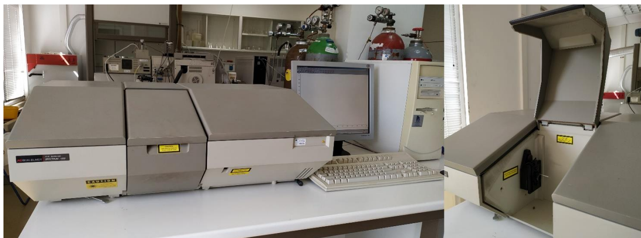
Εικόνα 30: Φασματοφωτόμετρο PERKIN ELMER SPECTRUM 1000
