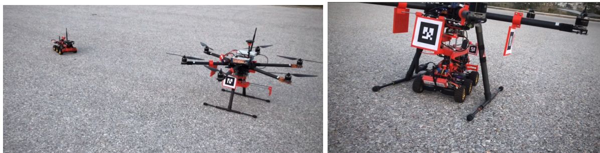
Σχήμα 5.7: Προσέγγιση και σύζευξη του UGV με το UAV
