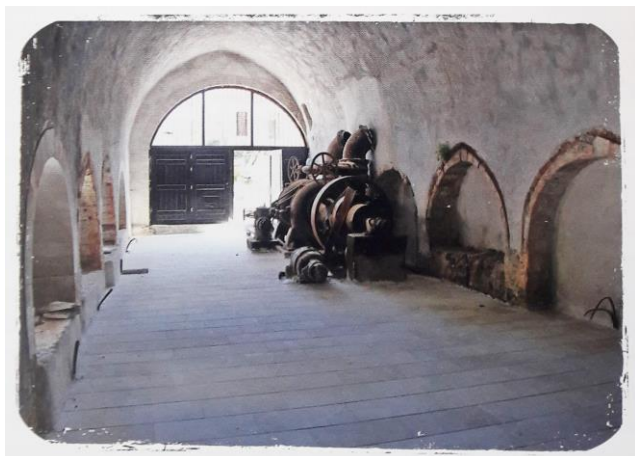
ΕΙΚΟΝΑ 52: Εσωτερικές απόψεις από το νερόμυλο των Καλυβών με τις τουρμπίνες που προστέθηκαν σε μετέπειτα φάση (ΠΗΓΗ: Μ. Βλαβογιλάκης, Καλύβες 2018, σελ. 74 (αριστερά) και προσωπικό αρχείο 2019 (δεξιά))
