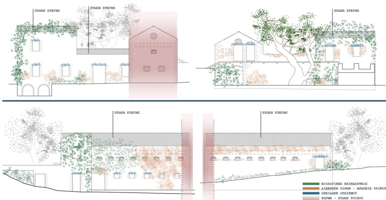
ΕΙΚΟΝΑ 41: Διαγράμματα αποτύπωσης της παθολογίας του συγκροτήματος (ΠΗΓΗ: προσωπικό αρχείο)
