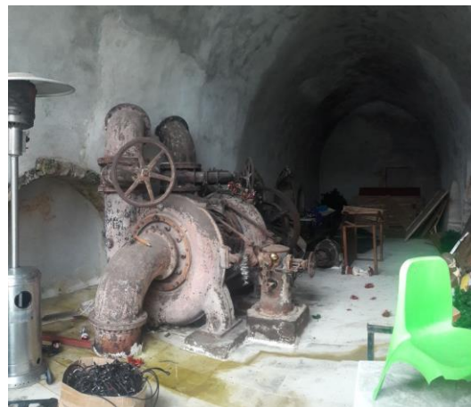
ΕΙΚΟΝΑ 52: Εσωτερικές απόψεις από το νερόμυλο των Καλυβών με τις τουρμπίνες που προστέθηκαν σε μετέπειτα φάση (ΠΗΓΗ: Μ. Βλαβογιλάκης, Καλύβες 2018, σελ. 74 (αριστερά) και προσωπικό αρχείο 2019 (δεξιά))
