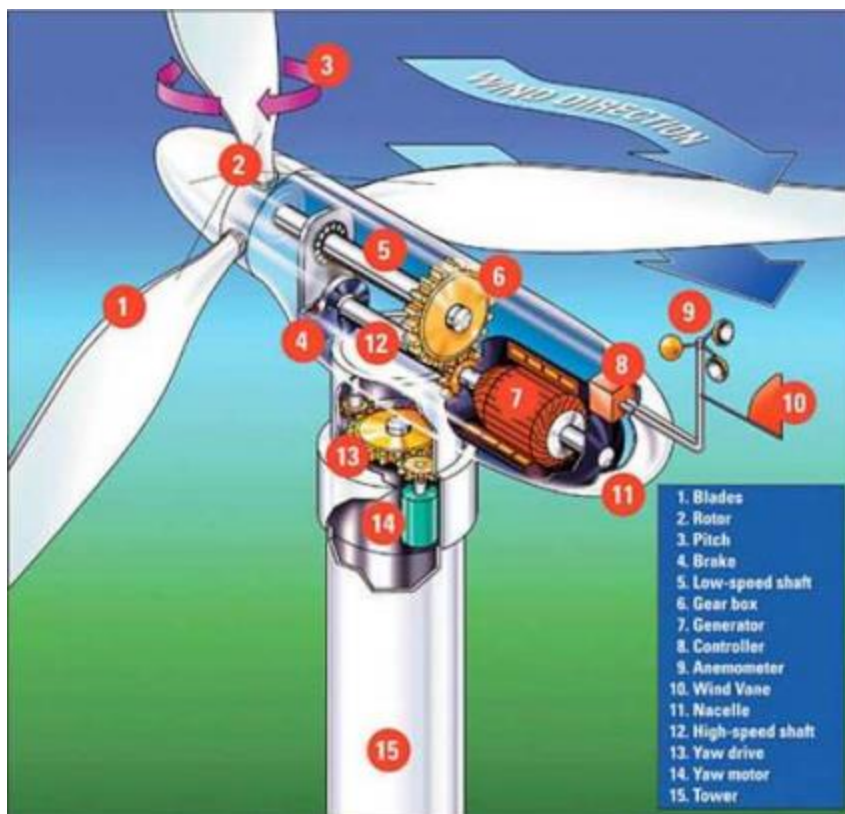
Σχήμα 2.1: Δομή μιας σύγχρονης ανεμογεννήτριας. [2]
