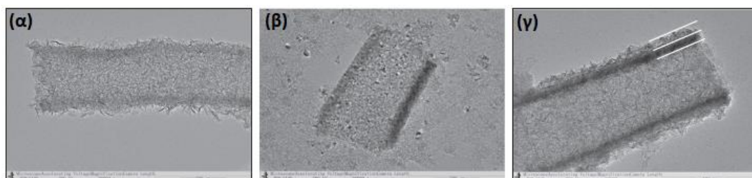
Σχήμα 18. Εικόνες TEM των νανο-σωλήνων: (α) \text{TiO}_2 , (β) \text{CeO}_2 και (γ) \text{TiO}_2/\text{CeO}_2 43 .
