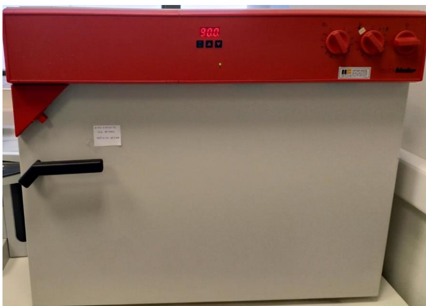
Εικόνα 1. Ο φούρνος όπου πραγματοποιείται η γήρανση του υδατικού διαλύματος ( \text{Ce}(\text{NO}_3)_3 \cdot 6\text{H}_2\text{O} , \text{TiOSO}_4 , \text{NaOH} ) στους 90 °C για 24 ώρες.
