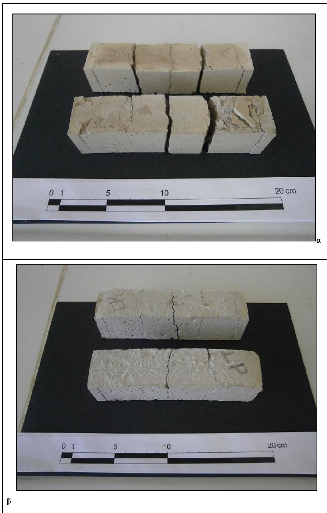
Εικόνα 9. Πρισματικά δοκίμια από τις συνθέσεις κονιαμάτων φυσικής υδραυλικής ασβέστου με ασβεστολιθικά αδρανή, έπειτα από τον έλεγχο της μηχανικής τους συμπεριφοράς στις 90 ημέρες ωρίμανσης (α. χωρίς ποζολάνη & β. με προσθήκη ποζολάνης).
