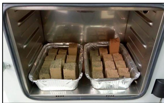
Εικόνα 13. Τμήματα των δοκιμών φυσικής υδραυλικής ασβέστου (ωρίμανση 90 ημερών), που χρησιμοποιήθηκαν στη μελέτη προσδιορισμού της υδατοαπορροφητικότητας (εμβάπτιση % ξήρανση).
