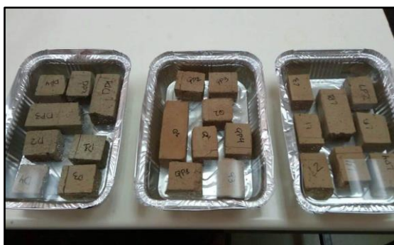
Εικόνα 13. Τμήματα των δοκιμών φυσικής υδραυλικής ασβέστου (ωρίμανση 90 ημερών), που χρησιμοποιήθηκαν στη μελέτη προσδιορισμού της υδατοαπορροφητικότητας (εμβάπτιση % ξήρανση).
