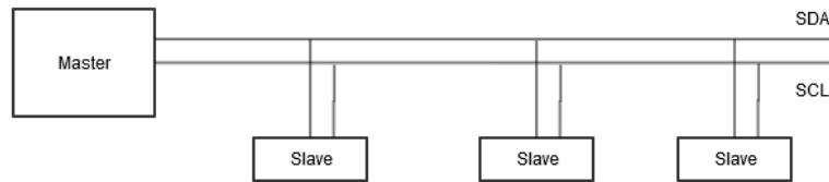
Σχήμα 1-11. I2C serial bus
