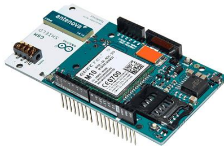
Σχήμα 3-22. Arduino GSM Shield
