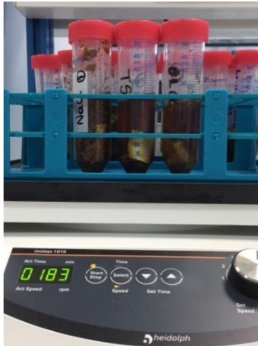
Εικόνα 12: Διαδικασία ανάδευσης των δειγμάτων σε ταχύτητα 180 rpm και θερμοκρασία 25 °C
