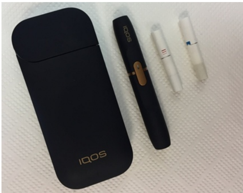
Εικόνα 2: Σύστημα IQOS, φορτιστής τσέπης, ράβδος θέρμανσης stick και tobacco stick (αριστερά είναι το stick που περιέχει αλουμίνιο γύρω από τον καπνό και δεξιά το TS που δεν περιέχει επιπλέον αλουμίνιο γύρω από τον καπνό)
