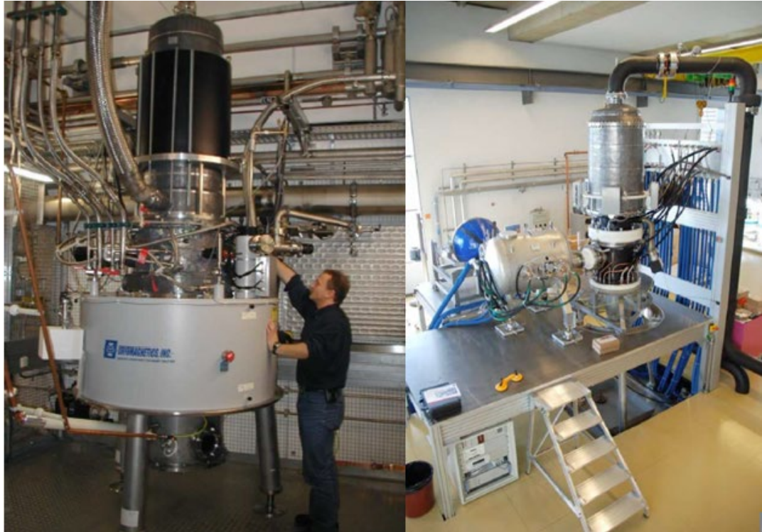
Εικόνα 1.4: Γυροτρόνια στο Karlsruhe Institute of Technology, ισχύος 2 MW [5].
