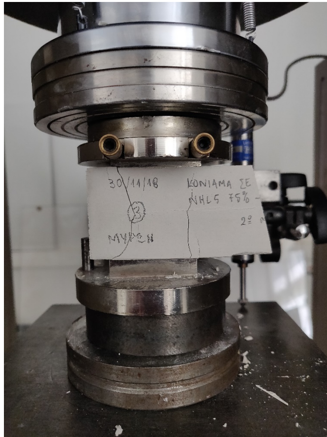
Εικόνα 4.2: Πρέσσα πειράματος μονοαξονικής θλίψης
