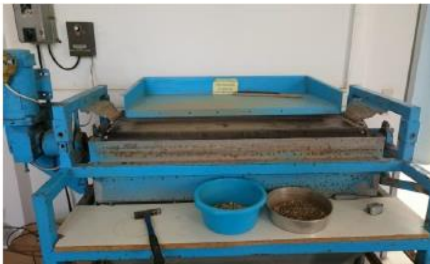
Εικόνα 16: Ταινιοφόρος μαγνητικός διαχωριστής (permgroll).
