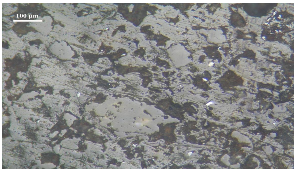
Εικόνα 24: Κόκκοι γκαιτίτη. Κοκκομετρικό κλάσμα -0,250 + 0,010 mm-μη μαγνητικό προϊόν έντασης 6A, ανακλώμενο φως // Nicols.
