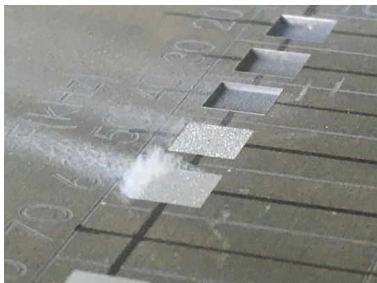
Σχήμα 5.1: Δημιουργία επιφανειακού στρώματος μετάλλου στις συνθήκες P=8W (40%), F=60 kHz και V=100 mm/sec
