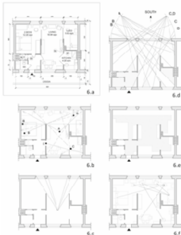
19. A.Klein Παράδειγμα ελάχιστης κατοικίας 67τ.μ. “Loggia” (type II B). Εδώ φαίνεται η μελέτη αερισμού, ηλιασμού και ελάχιστων κινήσεων για εργονομία.
