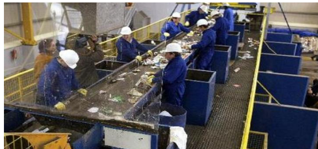
Εικόνα 8: Χειροδιαλογή αστικών απορριμμάτων από εργαζόμενους σε ΚΔΑΥ (Νταρακάς, 2014)
