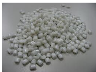
Εικόνα 21: Α) Πέλετς από πολυεστέρα (Alibaba) Β) Εξώθηση σε ίνες μετά από τήξη των πέλετς σε ειδική συσκευή (Extrusion) για τη παραγωγή νήματος, (CAF Extrusion) Γ) Νήμα από πολυεστέρα (Globalsources)
