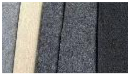
Εικόνα 22: Υλικά επένδυσης (τσόχες) για αυτοκίνητα μπορούν να φτιαχτούν από ανακυκλωμένες ίνες από πολυεστέρα (Indiamart)
