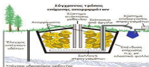
Εικόνα 1: Αρχή λειτουργίας ενός ΧΥΤΑ (ΕΛΛΗΝΙΚΗ ΕΤΑΙΡΕΙΑ ΔΙΑΧΕΙΡΙΣΗΣ ΣΤΕΡΕΩΝ ΑΠΟΒΛΗΤΩΝ)
