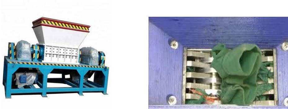
Εικόνα 18: i) Μηχάνημα τεμαχισμού ρούχων (εξωτερική όψη) (Alibaba) και ii) Δίσκοι με λεπίδες όπου περνά το ρούχο και τεμαχίζεται σε μικρά κομμάτια (Techandgeek)
