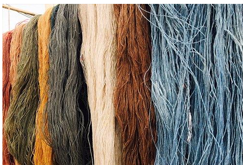
Εικόνα 25: Ανακυκλωμένα νήματα διαφορετικού χρώματος με διαφορετική χημική σύσταση παράγονται στην ολλανδική εταιρεία μηχανικής ανακύκλωσης Reblend (Εταιρεία Reblend)
