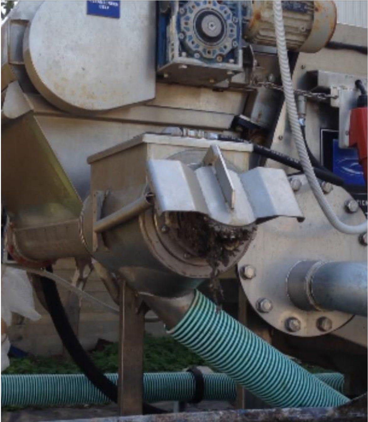
Εικόνα 2.4 Έξοδος της πρωτοβάθμιας λάσπης (βιοστερεών) από το μικροκόσκινο στην εγκατάσταση επεξεργασίας λυμάτων του Ρεθύμνου (Δ.Ε.Υ.Α.Ρ.) (Μπατιστάτος, 2017)
