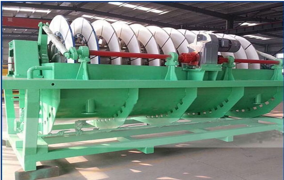
Εικόνα 1.8 Τυπική διάταξη Disc filter (911metallurgist)
