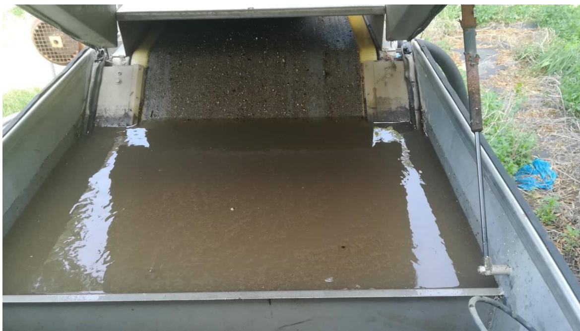
Εικόνα 2.3 Θάλαμος υποδοχής του υγρού απόβλητου, εμφάνιση της διαγώνιας κλίσης της μεμβράνης και της δημιουργία φιλμ από τα μικρότερα σε μέγεθος σωματίδια
