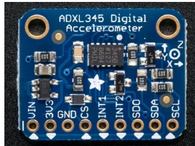
Σχήμα 3.28: Επιταχυνσιομέτρο ADXL345
