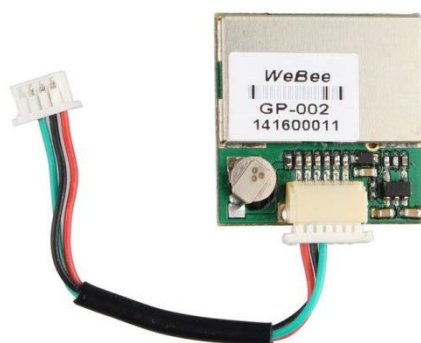
Σχήμα 3.27: Σύστημα Εντοπισμού Θέσης GPS
