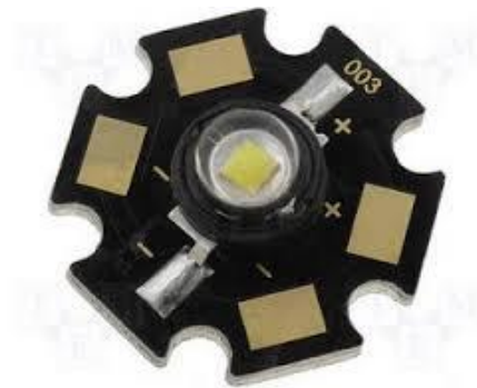
Σχήμα 3.30: Λαμπτήρας Cree Led Light ισχύος 3W
