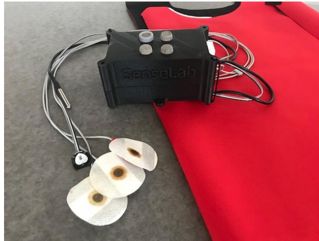
Σχήμα 4.9: Πρωτότυπο Βιομετρικό Γιλέκο
