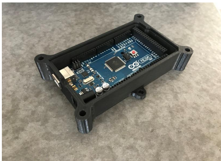
Σχήμα 4.10: Τοποθέτηση του μικροελεγκτή Arduino στην θήκη Guardian
