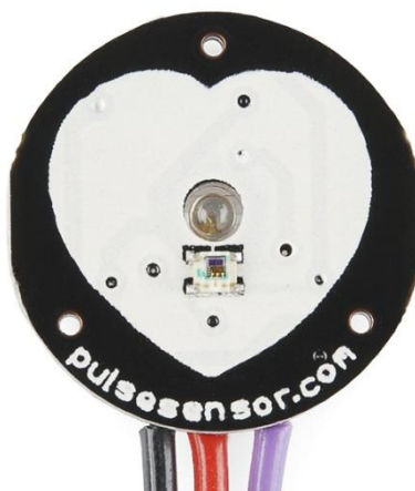
Σχήμα 3.11: Αισθητήρας μέτρησης καρδιακών παλμών (PPG)
