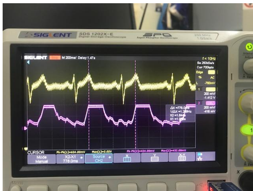
Σχήμα 6.1: Αποτελέσματα μέτρησης παλμών ανά λεπτό, εντός εργαστηρίου και απεικόνιση στον παλμογράφο
