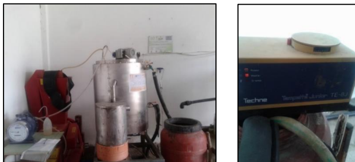
Εικόνα 21: Αντιδραστήρας CSTR, όπου διακρίνεται το μοτέρ ανάδευσης και ο μετρητής του παραγόμενου όγκου βιοαερίου (αριστερά) και το υδατόλουτρο με αντλία (δεξιά)
