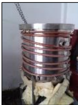
Εικόνα 20: Διάταξη έλικας θέρμανσης στον ενδιάμεσο χώρο του διπλότοιχου τοιχώματος του αντιδραστήρα
