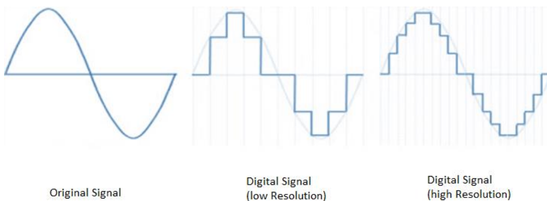
Εικόνα 32. Η ψηφιακή αναπαράσταση ενός σήματος γίνεται πιο ακριβής όσο αυξάνεται η ανάλυση, δηλαδή η περίοδος δειγματοληψίας
