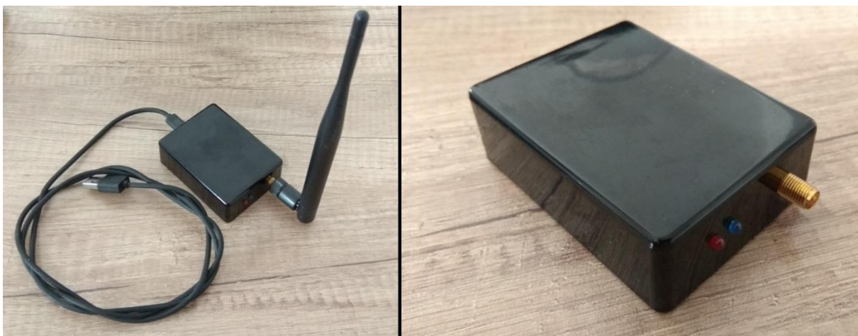
Εικόνα 47. Ο Βασικός κόμβος του συστήματος, που επιτρέπει τη διασύνδεση του Η/Υ με το δίκτυο των Αισθητήρων
