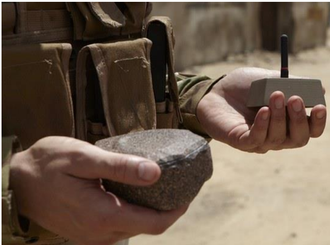
Εικόνα 1. Αυτόνομος Επίγειος Αισθητήρας για στρατιωτική χρήση που προσομοιώνει πέτρα, προϊόν της Αμερικάνικης εταιρίας Lockheed Martin ( https://www.wired.com/2012/05/spy-rock/ )
