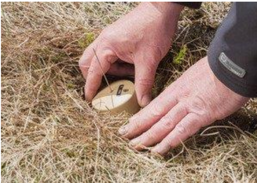
Εικόνα 3. Επίδειξη «ταφής» ενός Αισθητήρα μικρού μεγέθους στο έδαφος. Η κεραία του είναι απαραίτητο να προεξέχει για να είναι δυνατή η αποστολή σημάτων ( http://innovationmediadesign10.co.za/pathfinder/more-than-an-unattended-ground-sensor-the-evolution-of-e-ugs/ )
