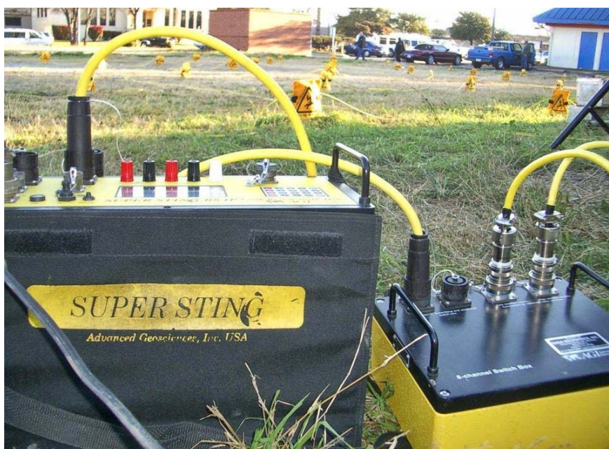
Εικόνα 1: Τυπική σύνδεση της μεθόδου ηλεκτρικής τομογραφίας
