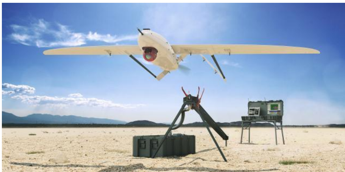
Εικόνα 20: Απογείωση ΜΕΑ με την βοήθεια καταπέλτη εδάφους (πηγή: UAV Factory)
