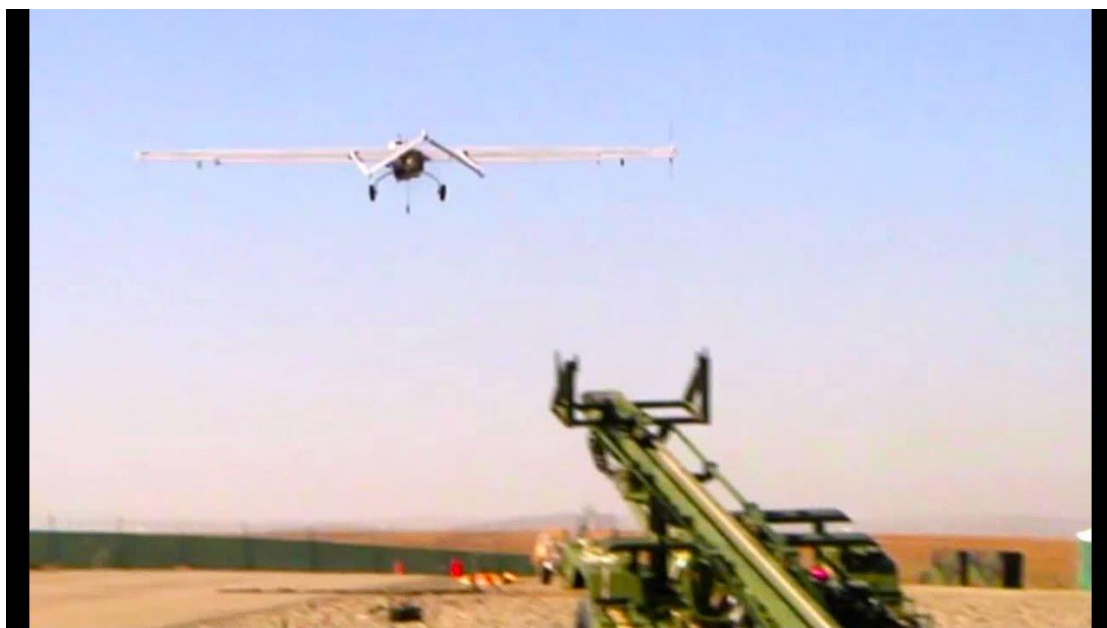
Εικόνα 21: Σύστημα απογείωσης του RQ-7 (πηγή: Aiir Source Military)
