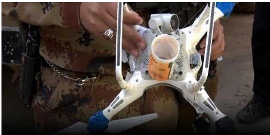
Εικόνα 1: Τροποποιημένο εμπορικό drone από το ISIS
