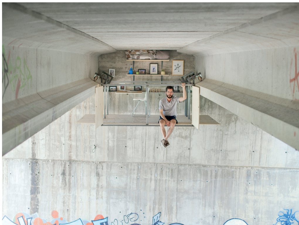
Εικ. 57_ Hidden studio: Το έργο του Fernando Abellanas είναι ένας χώρος εργασίας κρυμμένος και κρεμασμένος κάτω από μια γέφυρα αυτοκινητόδρομου στη Βαλένθια. Αποτελείται από σανίδες κόντρα πλακέ και μεταλλικούς σωλήνες όπου συγκρατούν τη κατασκευή, η οποία χρησιμοποιεί τον αυτοκινητόδρομο ως στέγη και τοίχους. Οι δοκοί της γέφυρας είναι αυτοί που επιτρέπουν την ξύλινη πλατφόρμα μέσω των οδηγών να μετατοπίζεται κατά μήκος της γέφυρας. Ο αρχιτέκτονας επιθυμεί την επανεξέταση τέτοιου τύπου χώρων και τη δημιουργία εναλλακτικών χρήσεων ως απάντηση στην έλλειψη αστικού χώρου.
