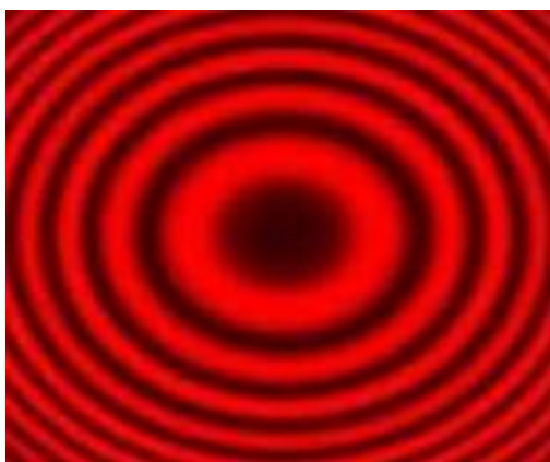
Εικόνα 9:Κροσσοί συμβολής για το κόκκινο Λείζερ
