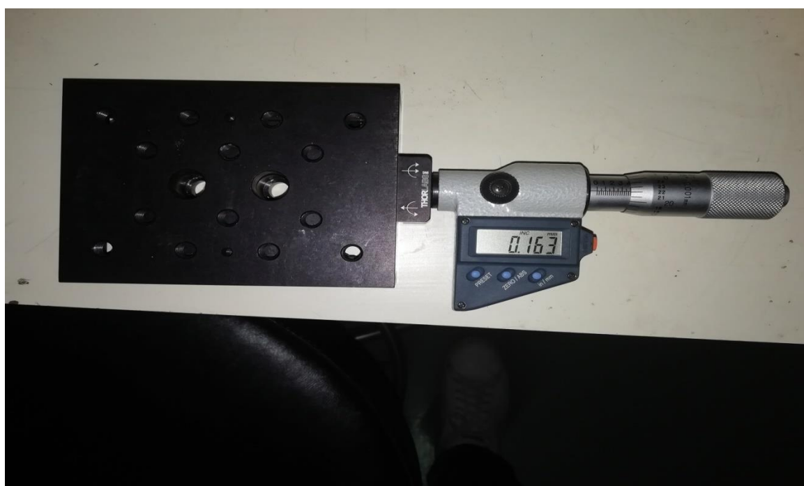
Εικόνα 8: Μικρόμετρο για την μετακίνηση του κατόπτρου
