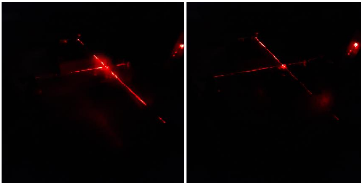
Εικόνα 34: Συμβολόμετρο Michelson για το κόκκινο λέιζερ
