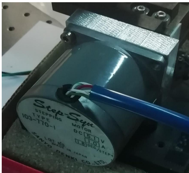
Εικόνα 14: Ο βηματικός κινητήρας της πειραματικής διάταξης
