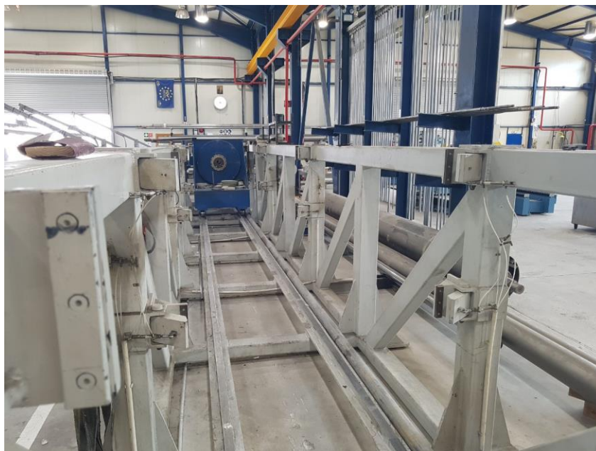
Σχήμα 2.20: Ο υδραυλικός εξολκέας, αφαιρεί το καλούπι μέσα από το, πολυμερισμένο πλέον, σύνθετο υλικό.
