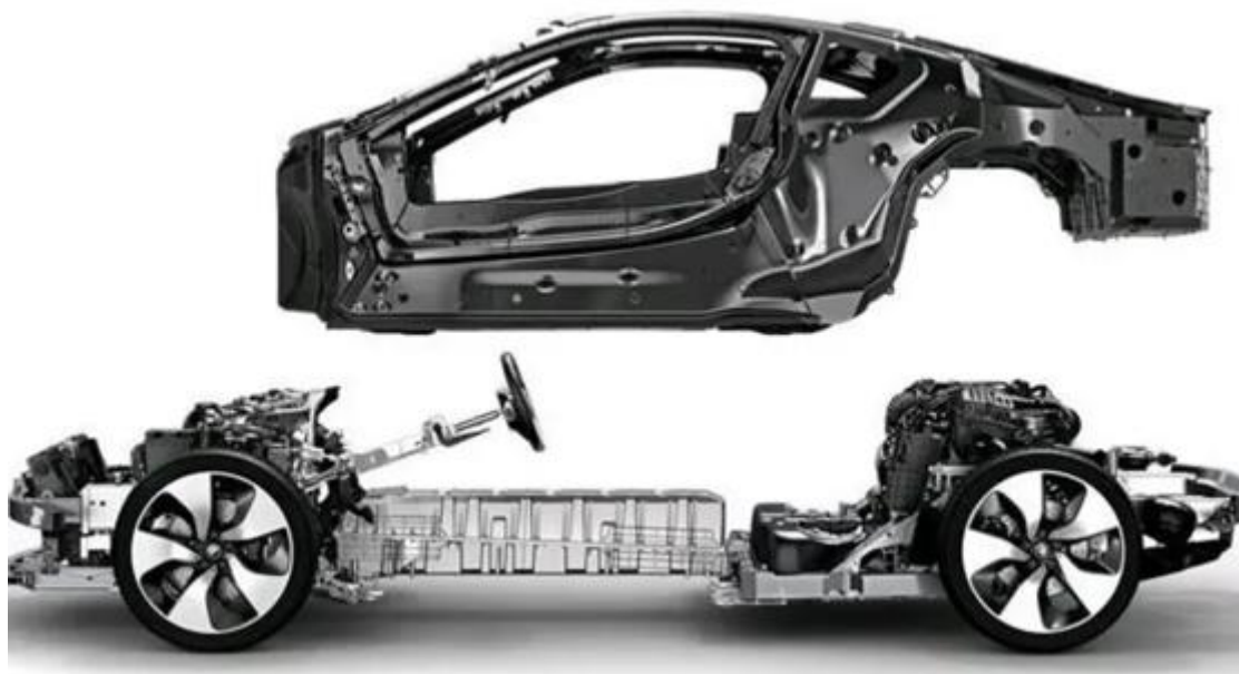
Σχήμα 2.7: BMW i8, το νέο ηλεκτροκίνητο μοντέλο της εταιρείας για το οποίο χρησιμοποιούνται σύνθετα υλικά για το μεγαλύτερο μέρος της κατασκευής του.
