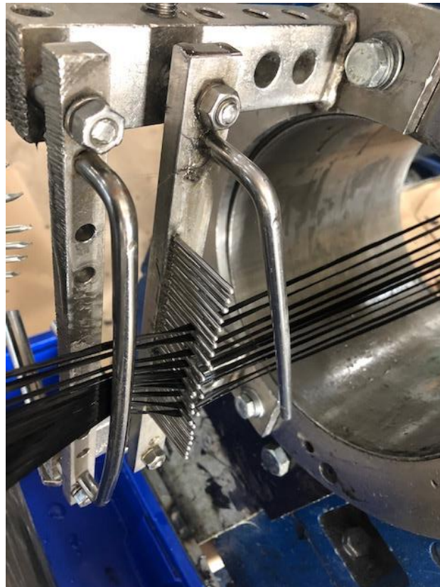
Σχήμα 2.17: Οι ίνες φτάνουν στο μάτι, διαχωρίζονται και τους αφαιρείται, η ποσότητα ρητίνης, αν τυχόν είναι πλεονάζουσα. Το μάτι περιστρέφεται και εναποθέτει τις ίνες άνω στο καλούπι, με την κατάλληλη γωνία πλέξης. Η γωνία πλέξης προσδιορίζεται από τον σχεδιαστή και εξαρτάται από τα φορτία που θα ασκούνται στο εκάστοτε εξάρτημα. Σύμφωνα με τη γωνία πλέξης, προγραμματίζεται κατάλληλα και η περιστροφή του ματιού.
