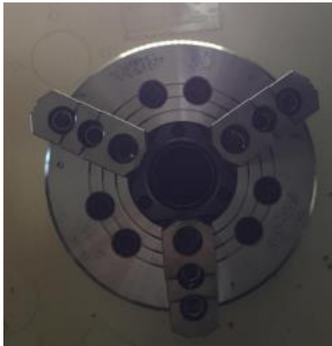
Σχήμα 4.8: Ο σφιγκτήρας (τσοκ) της εργαλειομηχανής DMG CTX310 ecoline.
