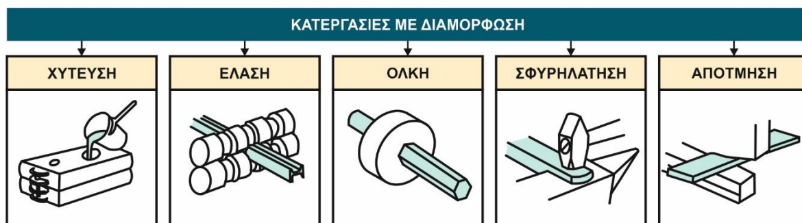
Σχήμα 4.2: Οι διαδικασίες διαμόρφωσης από αριστερά προς τα δεξιά: χύτευση, σφυρηλάτηση, απότμηση, όλκη και έλαση.
