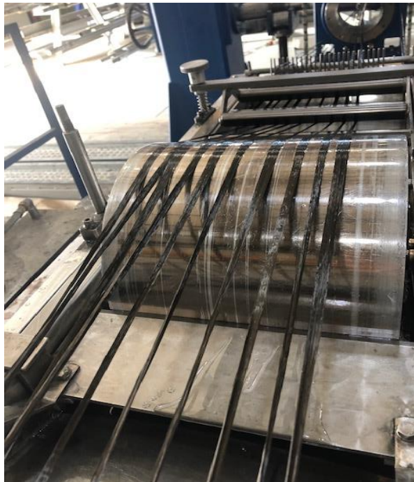
Σχήμα 2.16: Το τύμπανο της εικόνας περιστρέφεται συνεχώς, έχοντας συνεχώς βυθισμένη τη μια του πλευρά στο λουτρό ρητίνης. Οι ίνες απλώνονται πάνω του και παίρνουν ακριβώς όση ρητίνη χρειάζονται.
