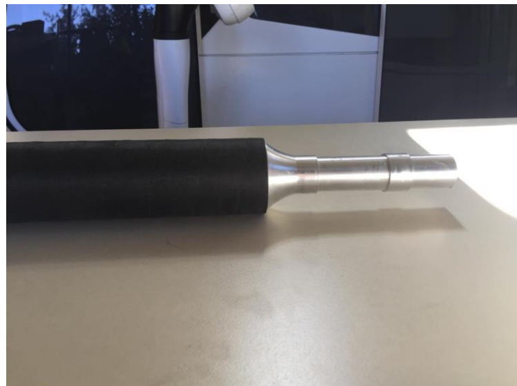
Σχήμα 4.9: το 2 ο τεμάχιο συνδεδεμένο με το ανθρακονημάτινο άξονα.
