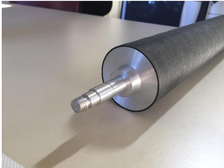
Σχήμα 4.10: το 3 ο τεμάχιο συνδεδεμένο με το ανθρακονημάτινο άξονα.
