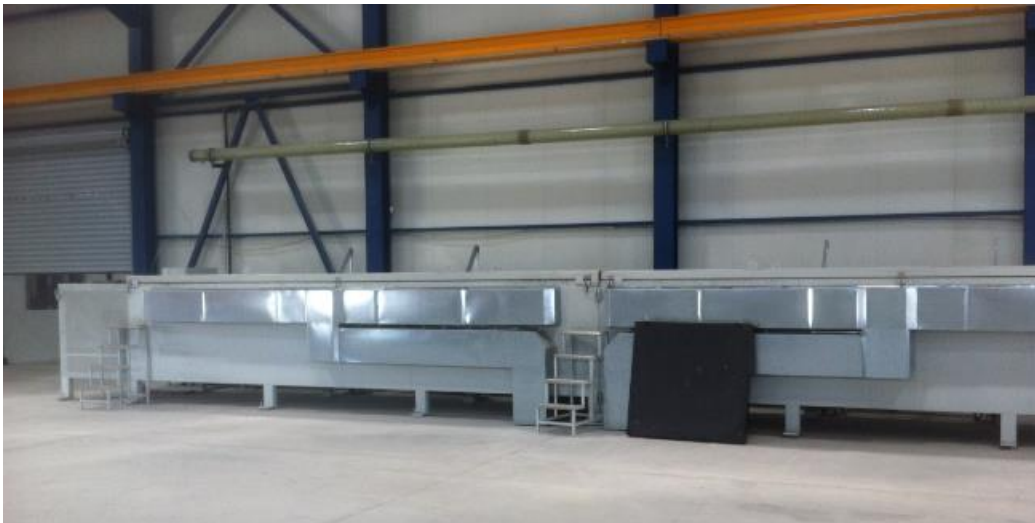
Σχήμα 2.19: Ο φούρνος πολυμερισμού έχει τη δυνατότητα να ελέγχει τη θερμοκρασία και τη διάρκεια της διαδικασίας. Το καλούπι με το εμποτισμένο με ρητίνη, πλέον, ανθρακόνημα συνεχίζει να περιστρέφεται, ώστε το τελικό προϊόν, να μην πά-ρει ανεπιθύμητες παραμορφώσεις και να μη διαφύγει ποσότητα ρητίνης κατά τη διάρκεια της διαδικασίας.
