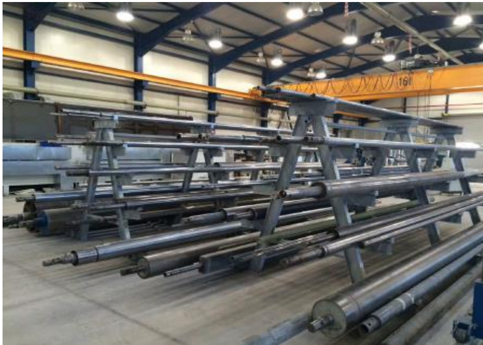
Σχήμα 2.12: Μερικά από τα καλούπια που χρησιμοποιούνται για την κατασκευή κυλινδρικών εξαρτημάτων με τη τεχνική της περιέλιξης ινών.
