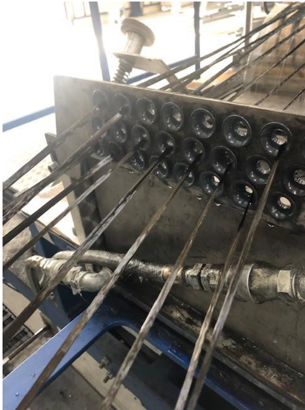
Σχήμα 2.15: Οι ίνες οδηγούνται στο λουτρό ρητίνης, μέσω κεραμικών οπών, για να αποφευχθούν ανεπιθύμητοι τραυματισμοί των ινών.
