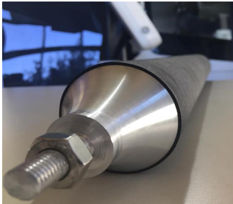
Σχήμα 4.11: το 4 ο τεμάχιο συνδεδεμένο με το ανθρακονημάτινο άξονα.
