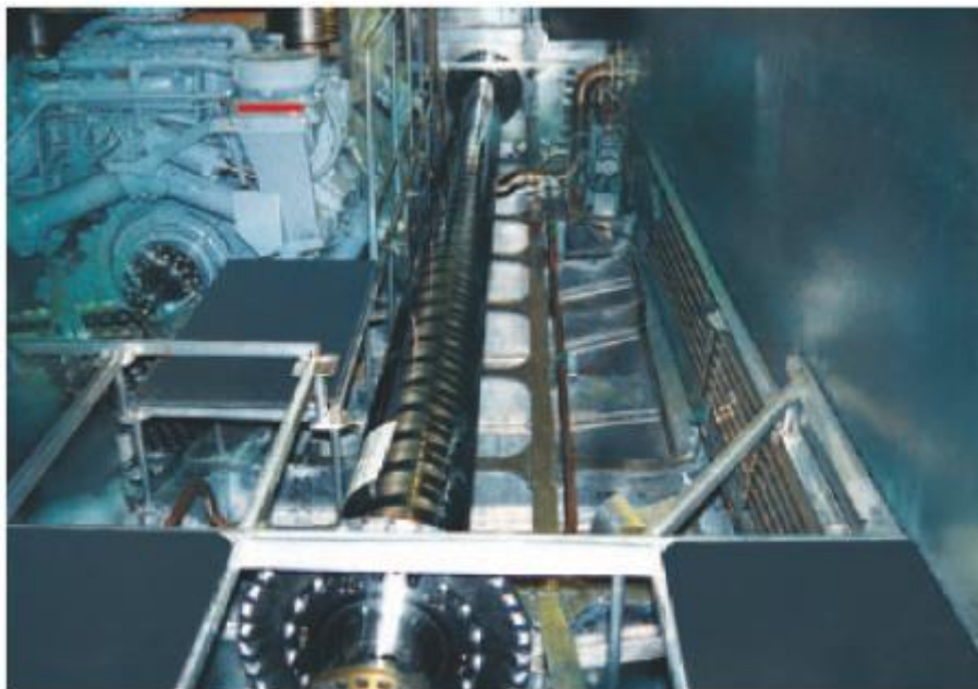
Σχήμα 2.9: Άξονας του "Flying Cat", της εταιρίας CENTA.
