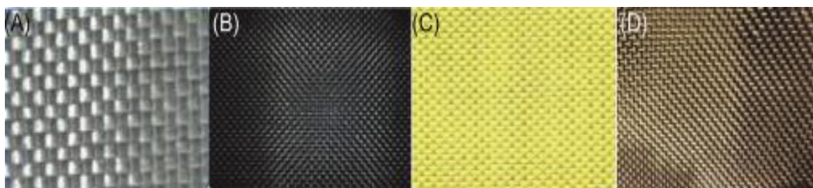
Σχήμα 2.3: Είδη υφασμάτων, που χρησιμοποιούνται ως υλικά ενίσχυσης για την κατασκευή σύνθετων υλικών. (Α) Υαλόνημα, (Β) Ανθρακόνημα, (Γ) Αραμίδιο, (Δ) Βασάλτης.
