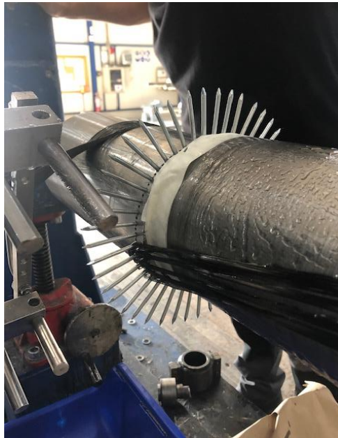
Σχήμα 2.18: Οι ίνες φτάνουν στο καλούπι με τη κατάλληλη γωνία πλέξης. Το στεφάνι με τα καρφιά, επιτρέπει την αλλαγή κατεύθυνσης του φορέα κατά 180°, χωρίς να παρασύρει τις ίνες.
