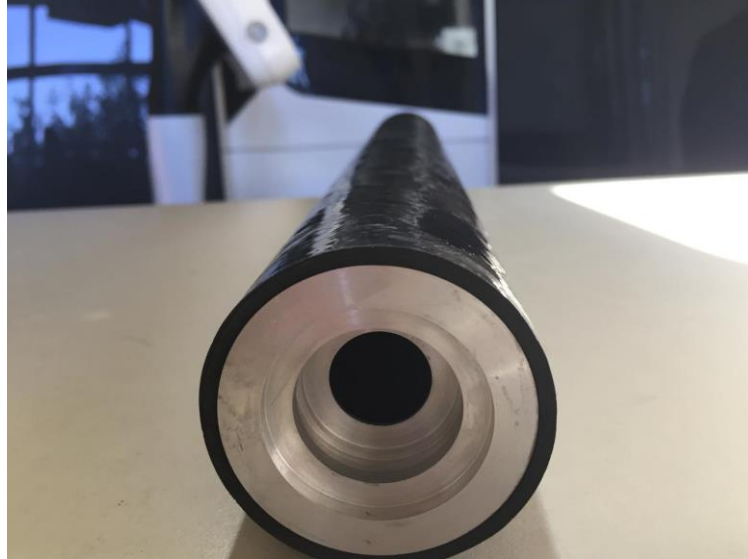
Σχήμα 4.8: το 1 ο τεμάχιο συνδεδεμένο με το ανθρακονημάτινο άξονα.
