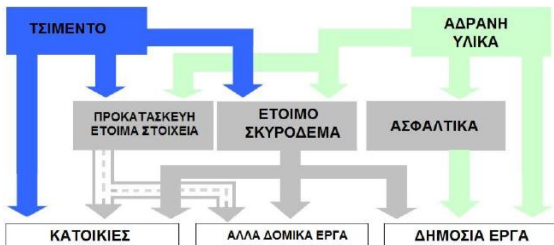
Εικόνα 11. Πρώτες ύλες και προϊόντα της βιομηχανίας τσιμέντου και του σκυροδέματος 31
