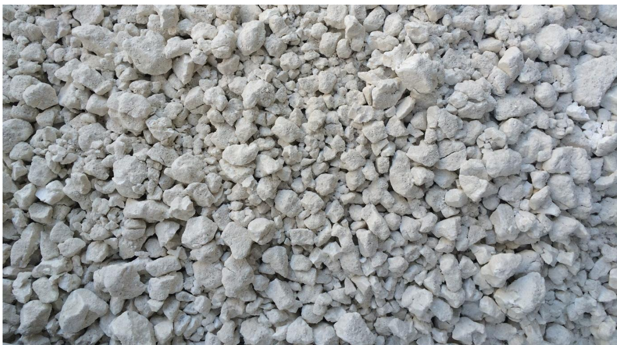
Εικόνα 5. Ασβεστος ( \text{CaO} ) σε μορφή τεμαχίων μικρής διάστασης περίπου 7-8 cm έτοιμος προς σβέση.
