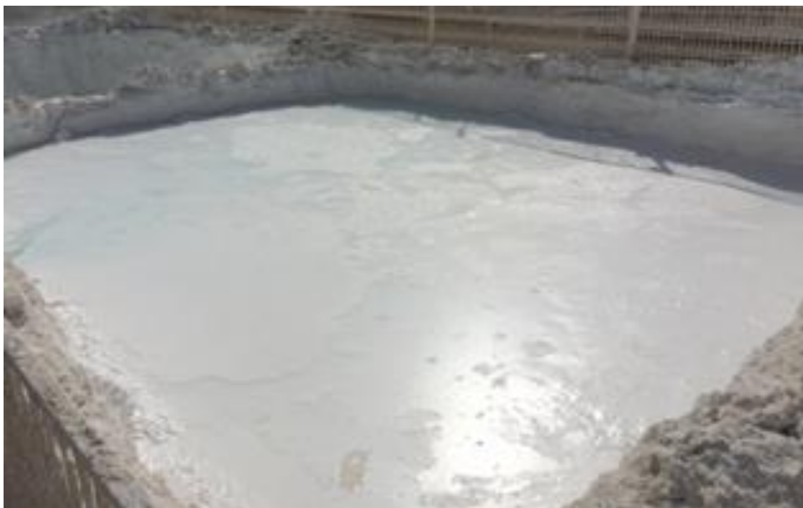
Εικόνα 7. Ασβεστοπολτός για οικοδομική χρήση κατάλευκος, πηκτός σβησμένος ασβέστης έτοιμος προς χρήση. Διατίθεται σε πλαστικούς σάκους των 20 κιλών περίπου, σε big bags 0.50 ή 0.70 κυβ. μέτρου η χύδην σε φορτηγά. 20
