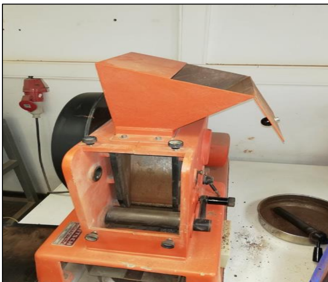
Εικόνα 17: Σιαγωνοτός σπαστήρας Fritsch pulverisette 1 στο Εργαστήριο Εμπλουτισμού του Πολυτεχνείου Κρήτης
