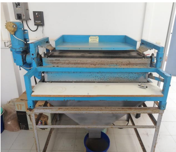
Εικόνα 11: Ταινιοφόρος μαγνήτης διαχωριστής Perm role στο Εργαστήριο Εμπλουτισμού του Πολυτεχνείου Κρήτης
