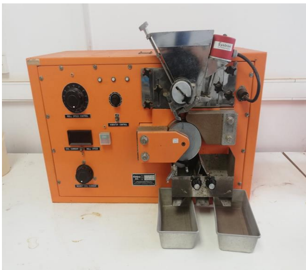
Εικόνα 13: Μαγνητικός διαχωριστής υψηλής έντασης (High induced Role) στο εργαστήριο εμπλουτισμού του Πολυτεχνείου Κρήτης
