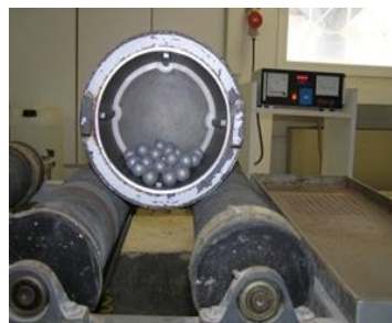
Εικόνα 8: Εσωτερικό σφαιρόμυλου
