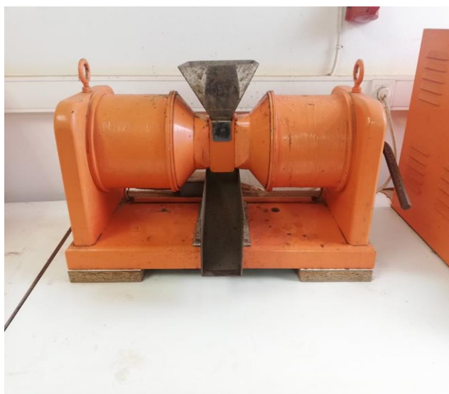
Εικόνα 14: Υγρός μαγνητικός διαχωριστής υψηλής κλίσης πεδίου, του Εργαστηρίου Εμπλουτισμού του Πολυτεχνείου Κρήτης.
