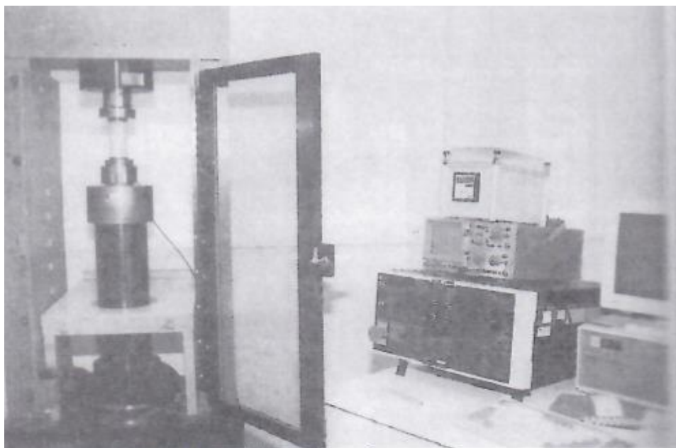
Εικόνα 5.1: Απεικόνιση θλιπτικού συστήματος θλιπτικών δοκιμών (Αγιουτάντης, 2010).
