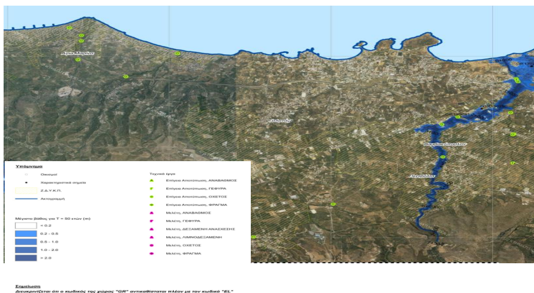
Εικόνα 3.4: Απόσπασμα χάρτη επικινδυνότητας πλημμύρας για περίοδο επαναφοράς T=50 έτη (GR13-P05-SX1)
