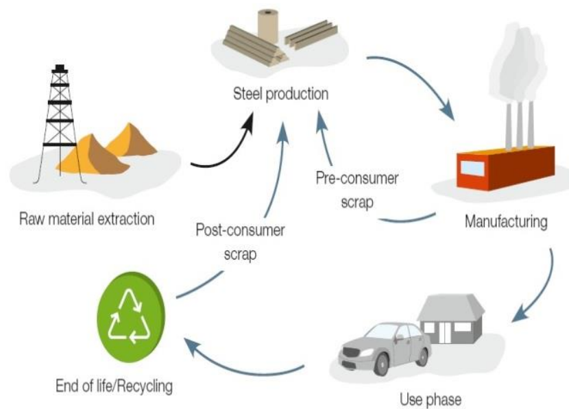
Εικόνα 3.5 Κύκλος Ζωής Χάλυβα [10].
