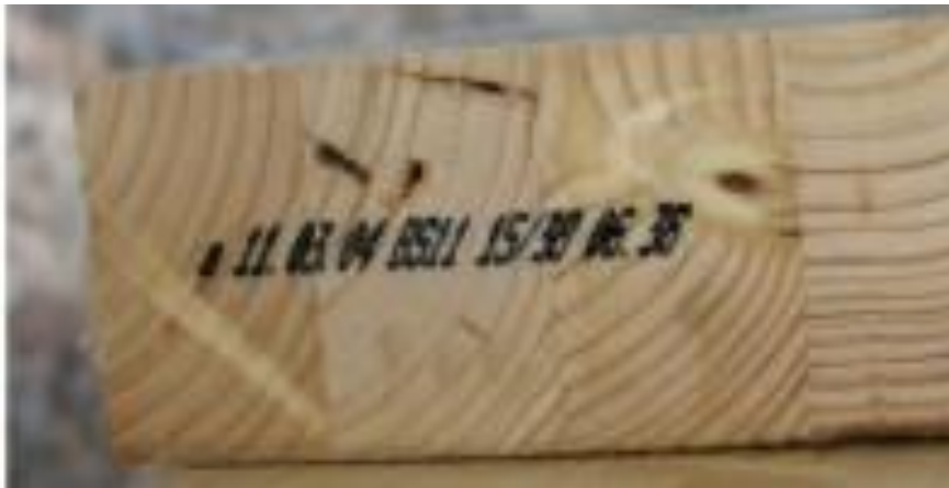
Εικόνα 3.12 Σφραγίδα πιστοποίησης αντοχής και ποιότητας, στο σόκορο ξύλινου μέλους [15].
