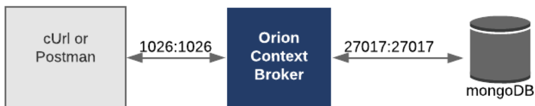
Εικόνα 2.3: Η επικοινωνία του Orion Context Broker με χρήστες/υπηρεσίες (αριστερά) και με τη βάση δεδομένων MongoDB (δεξιά).
