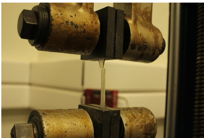
Εικόνα 27: δοκίμιο που έχει σπάσει αφού πέρασε το όριο αντοχής του στο μηχάνημα instron
