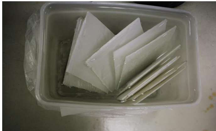
Εικόνα 17: Πλάκες σε θαλασσινό νερό κλεισμένες αεροστεγώς
