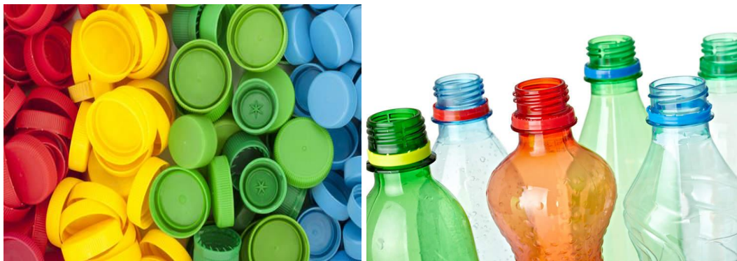
Εικόνα 11: παράδειγμα πλαστικών μπουκαλιών PET και διαχωρισμός τους από τα καπάκια τους (LDPE) για διαφορετική ανακύκλωση
