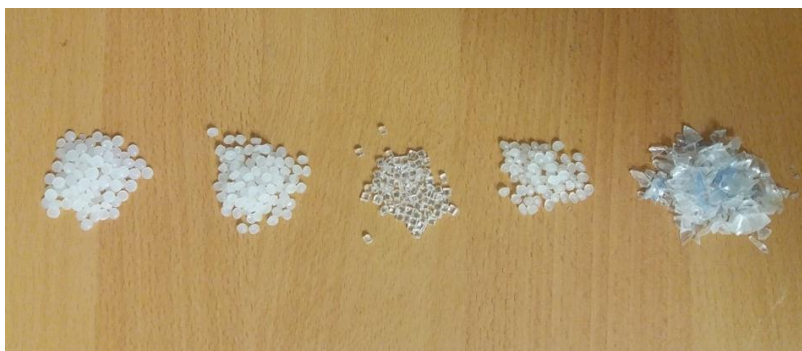
Εικόνα 12: ανακυκλώσιμα πολυμερή από HDPE, LDPE, PS, PP και PET
