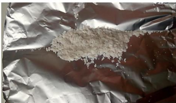
Εικόνα 28: : μικροπλαστικό που δημιουργήθηκε από το τρίψιμο της πλάκας με μεταλλική λίμα
