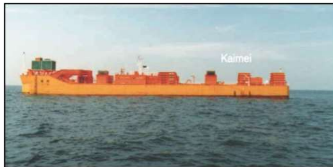
Εικόνα 2.2: Ο Ιαπωνικός πλωτός μετατροπέας της κυματικής ενέργειας Kaimei (Πηγή: Modeling of Wave Energy Conversion by Antonio F.O. Falcao, Instituto Superior Técnico, Universidade de Lisboa, 2017).
