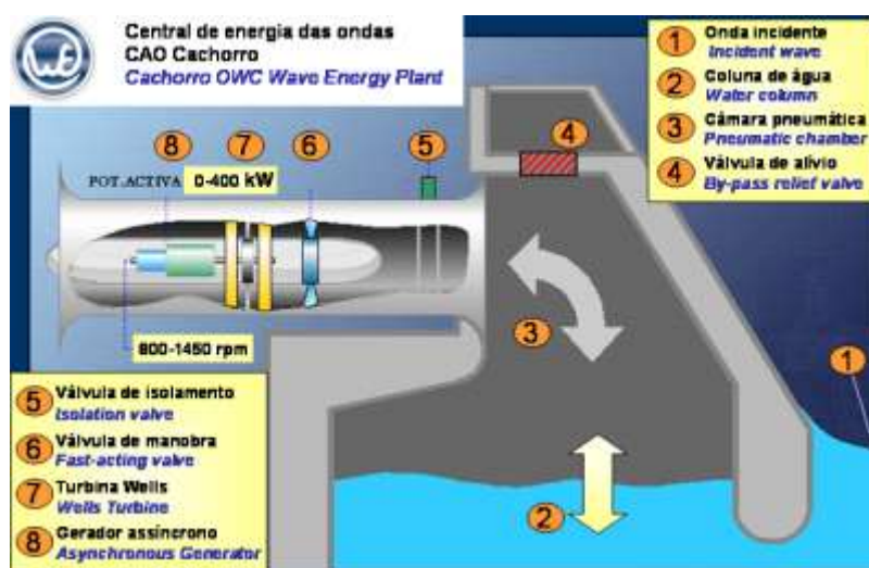
Εικ.2.28.: Απεικόνιση λειτουργίας της εγκατάστασης Rico (Πηγή: http://www.pico-owc.net/gallery/ )
