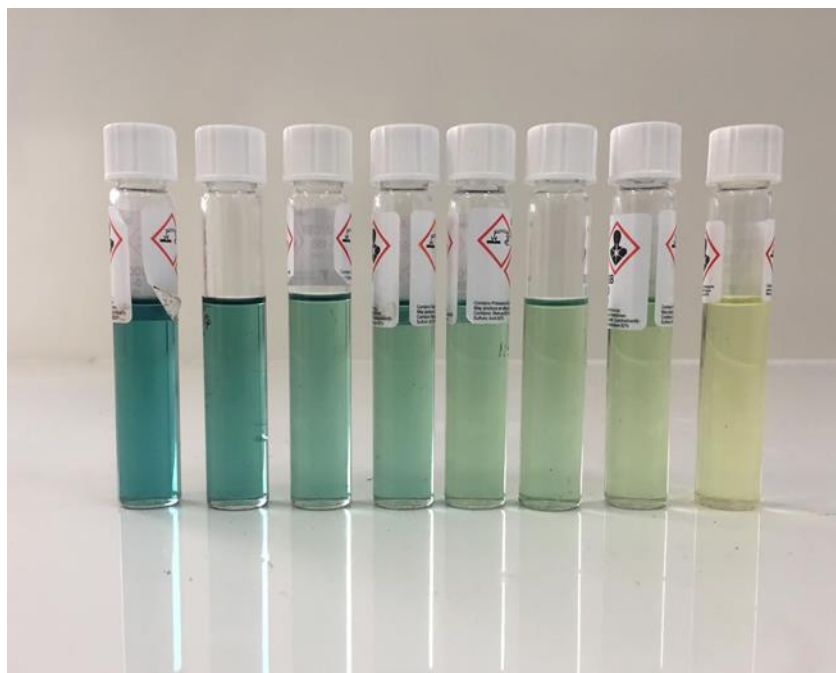
Εικόνα 21 : Φιαλίδια πρότυπων διαλυμάτων με σχηματισμό της έγχρωμης ένωσης της ανθρόνης αρχικής συγκέντρωσης 100 mg/L
