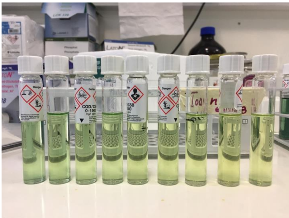
Εικόνα 20 : Φιαλίδια πρότυπων διαλυμάτων με σχηματισμό της έγχρωμης ένωσης του ορού αλβουμίνης βοδιού (BSA) αρχικής συγκέντρωσης 100 mg/L.
