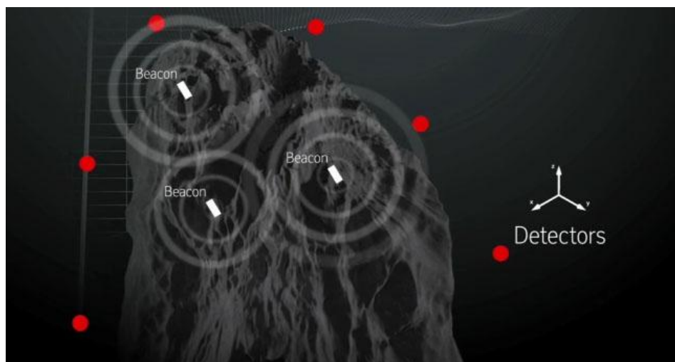
Σχήμα 2.15 : Αναπαράσταση συστήματος παρακολούθησης κατακρήμνισης (Rio Tinto, 2016)
