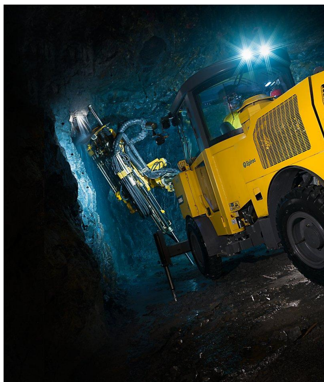
Σχήμα 4.2: Διατρητικό Epiroc SIMBA S7 για άνωθεν ακτινικά διατρήματα
