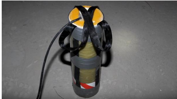
Σχήμα 2.14: Δείκτης συστήματος παρακολούθησης κατακρήμνισης (Rio Tinto, 2016)
