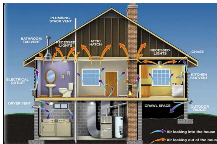
Εικόνα 3. 3 Θερμικές απώλειες λόγω αερισμού
