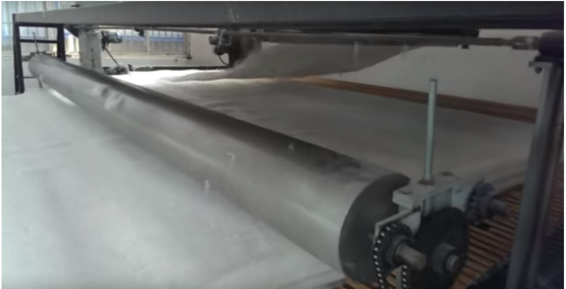
Εικόνα 2.3.5.9: Σύστημα αναδίπλωσης των άνευ υφάνσεως πολυεστερικών φύλλων.
