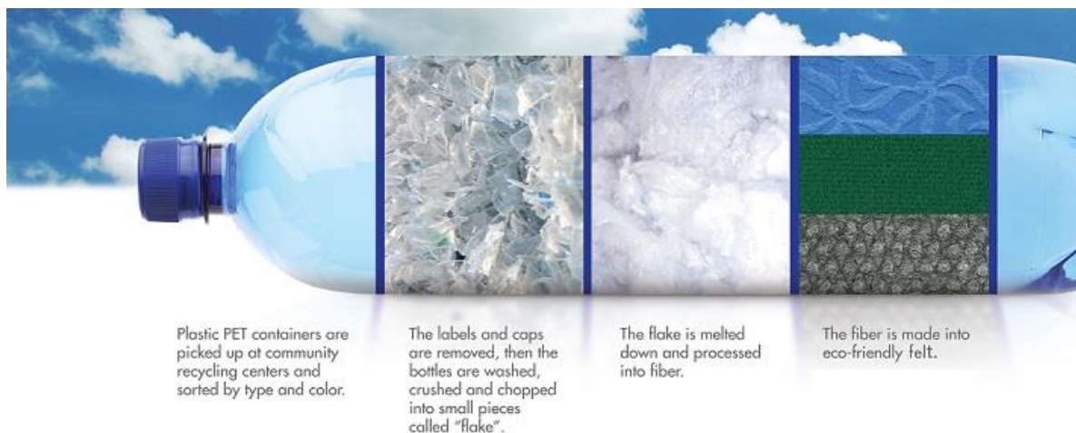
Εικόνα 2.3.5.1: Στάδια επεξεργασίας μπουκαλιών PET, για παραγωγή άνευ υφάνσεως πολυεστερικών πλακών
