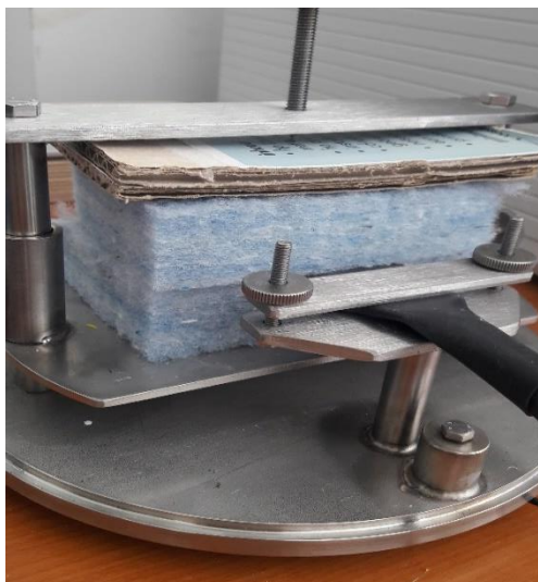
Εικόνα 3.4.1: Τοποθέτηση δείγματος στο σύστημα στήριξης. (το χαρτόνι δεν επηρεάζει τις μετρήσεις τοποθετήθηκε μόνο για την καλύτερη σταθεροποίηση του δείγματος)
