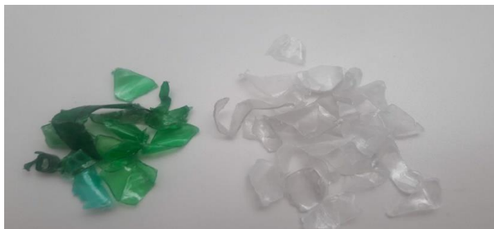
εικόνα 2.3.5.1: 1 ο αποτέλεσμα τεμαχισμού μπουκαλιών PET
