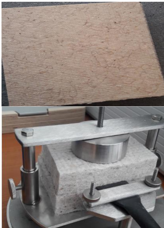
Εικόνα 4.2.2: Άνευ υφάνσεως πλάκα με σύσταση 20% κοκοφοίνικα
