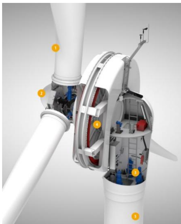
Εικόνα 6.4 Μέρη ανεμογεννήτριας EWT – DW54. [7]
